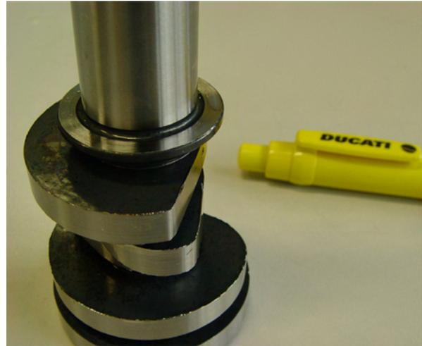
Die Desmodromik-Nockenwelle ist keine herkömmliche Nockenwelle und wurde mit speziellen „Heberampen“ konstruiert
