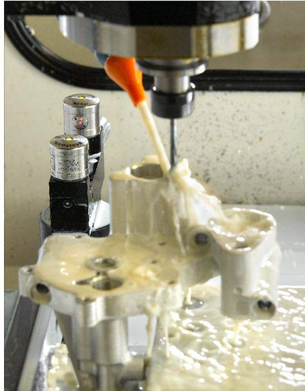
Renishaws NC4 Laserwerkzeugkontroll-System wird verwendet, um Beschädigungen an sehr teuren Bauteilen durch defekte Werkzeuge zu vermeiden – Ausschuss, Nacharbeit und Zeitverschwendung werden dadurch ausgeschlossen
