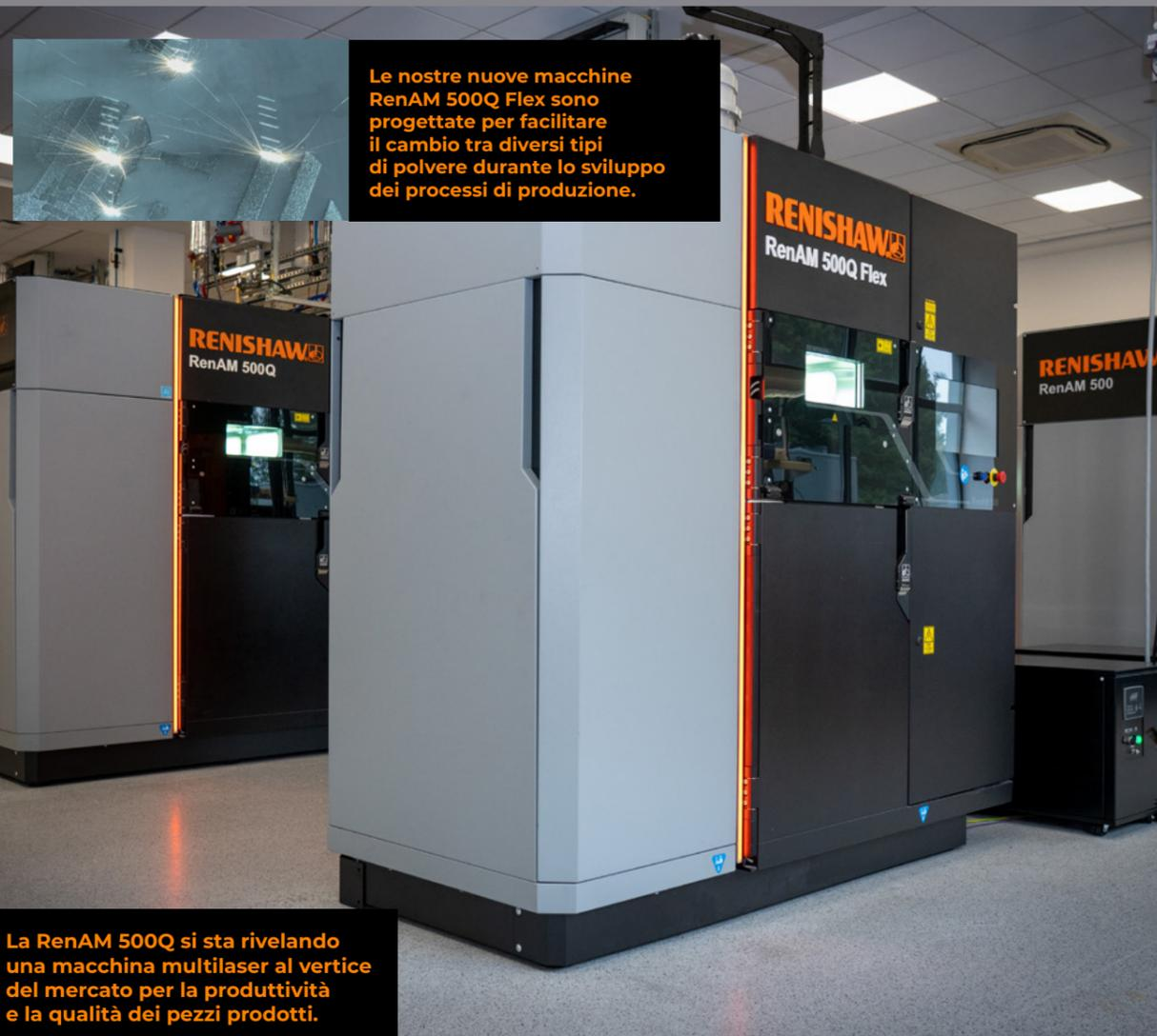
**Le nostre nuove macchine RenAM 500Q Flex sono progettate per facilitare il cambio tra diversi tipi di polvere durante lo sviluppo dei processi di produzione.**
