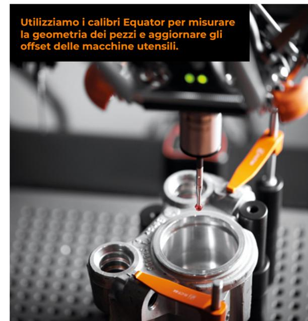
Utilizziamo i calibri Equator per misurare la geometria dei pezzi e aggiornare gli offset delle macchine utensili.
