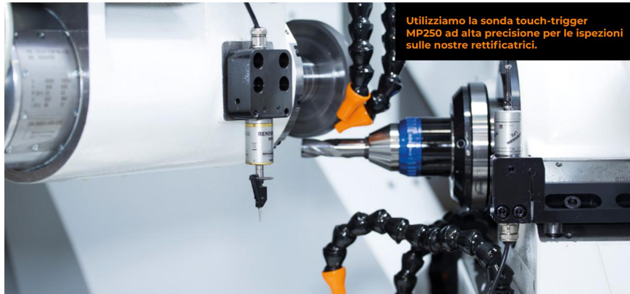
Utilizziamo la sonda touch-trigger MP250 ad alta precisione per le ispezioni sulle nostre rettificatrici.
