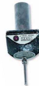
**Lanciamo il nostro primo prodotto:** La sonda a contatto TP1 di Renishaw rivoluziona l'ispezione automatizzata di pezzi meccanici sulle CMM.
