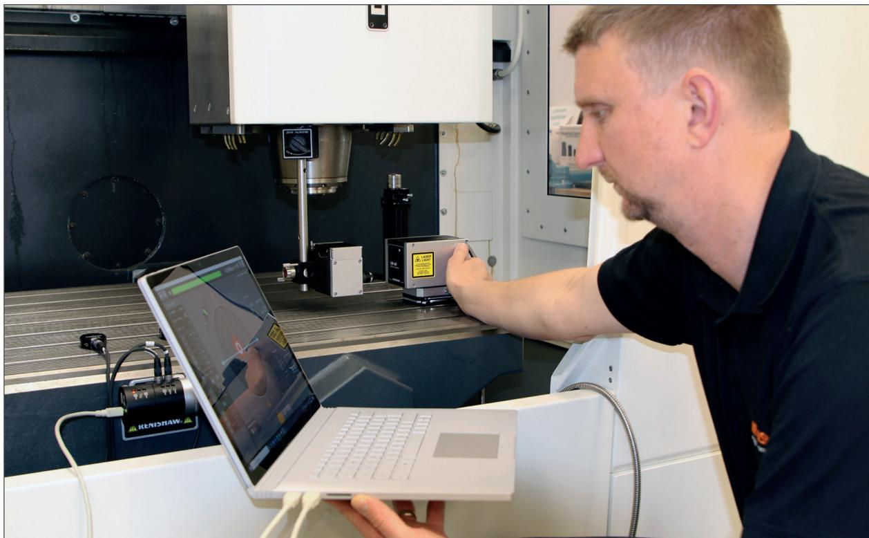
O calibrador multieixos XM-60 proporciona aos usuários um recurso poderoso de diagnóstico da máquina através da medição de todos os graus de liberdade a partir de um “único tiro”. Na captura com seis graus de liberdade, os usuários podem descobrir a fonte de seus erros e não apenas seus efeitos, muitas vezes vistos quando é realizada apenas a medição linear.
