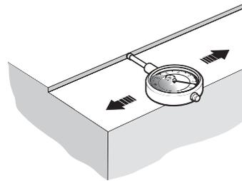
2. Überprüfen Sie die Ausrichtung der Nut / Kante in Bezug auf die Bewegungsachse (siehe ‚Installationszeichnung für RTALC40 / *FASTRACK* System‘ auf Seite 11).
