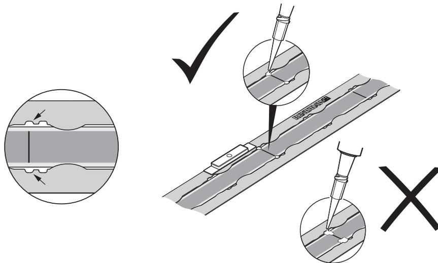
**HINWEIS:** Tragen Sie nur Loctite 435 in diesen Spalten auf, um eine optimale Haftung zu gewährleisten. Loctite 435 fließt unter das Maßband, um dort eine feste Verbindung zu erzeugen.
