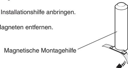
3. Den Magneten an der gewünschten Position fluchtend zur Außenkante des *FASTRACK* Trägers anbringen und sicherstellen, dass er nicht auf der Maßverkörperung sitzt.
