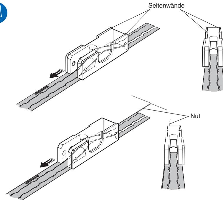
6. Führen Sie das RTLC40 Maßband in den *FASTRACK* Träger *ein*. Vergewissern Sie sich, dass das Maßband wie unten dargestellt unter den Auskragungen verlegt wird. Sie können das RTLC40 Maßband von Hand installieren, indem Sie es entweder durch den *FASTRACK* Träger ziehen oder schieben. Alternativ kann auch die optionale Montagehilfe für RTL Maßbänder verwendet werden (siehe Abbildung unten).
