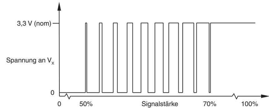
Bei einer Signalstärke zwischen  $50\%$  und  $70\%$  ist  $V_x$  ein Rechtecksignal. Je höher die Signalstärke, desto länger sind die inkrementellen High-Pegel. Bei einer Signalstärke  $> 70\%$  beträgt  $V_x$  durchgehend  $3,3 \text{ V}$ .
