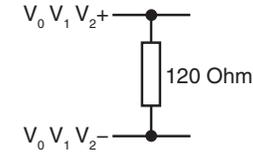
**HINWEIS:** Ein Abschlusswiderstand von 120 Ohm an den analogen Ausgangssignalen ist für eine korrekte Ausführung der AGC Funktion unbedingt erforderlich.
