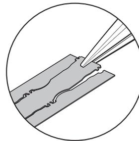
4. Entfernen Sie die Schutzfolie an der Rückseite des *FASTRACK* Trägers und positionieren Sie ihn entlang der Nut / Führungskante oder der Stifte auf den Untergrund. Drücken Sie das *FASTRACK* an, indem Sie mit dem Finger fest von der Mitte in beide Richtungen streichen. Verwenden Sie hierbei ein faserfreies Tuch.
