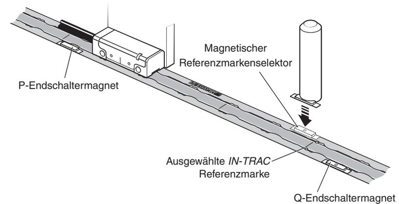
4. Den Magneten mit einem sauberen, trockenen, faserfreien Tuch mit den Fingern festdrücken, um sicherzustellen, dass er gut haftet.
