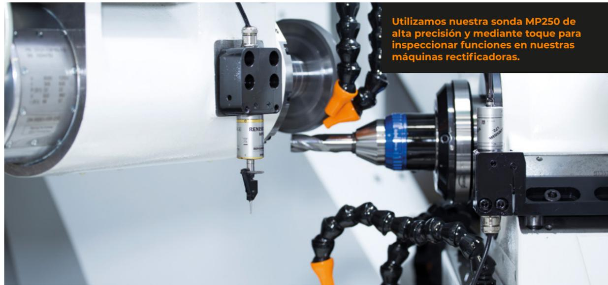
Utilizamos nuestra sonda MP250 de alta precisión y mediante toque para inspeccionar funciones en nuestras máquinas rectificadoras.
