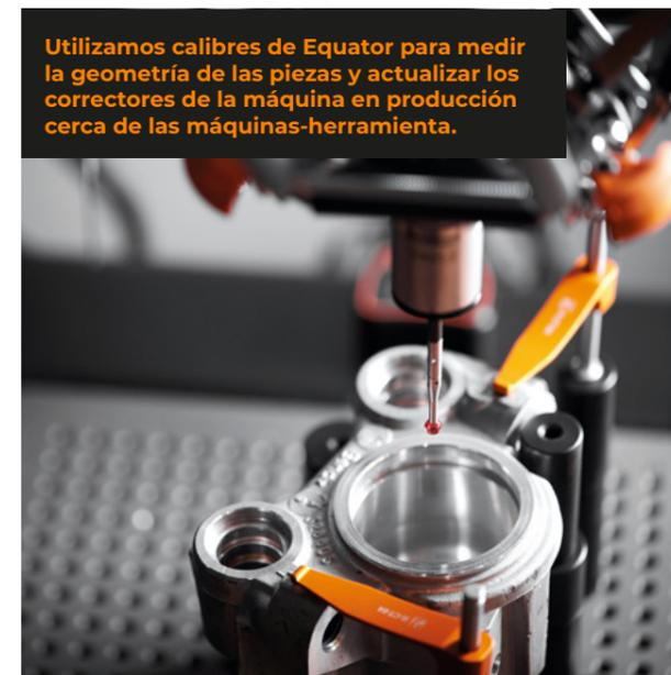
Utilizamos calibres de Equator para medir la geometría de las piezas y actualizar los correctores de la máquina en producción cerca de las máquinas-herramienta.
