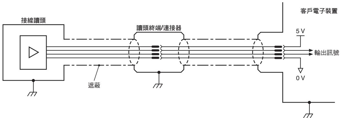
重要：屏蔽應接至機器接地 (現場接地)。針對 JST 版本，金屬環應連接至機器接地。
