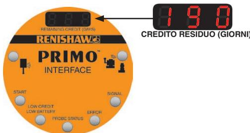
4. Credito e batteria in esaurimento indicati dall'uscita del relè SSR dell'interfaccia (che può essere connessa al controllo della macchina). Quando il credito è in esaurimento, il relè cambia stato. Il relè SSR può essere configurato come normalmente aperto oppure normalmente chiuso. Per maggiori informazioni, vedere "Configurazione dell'uscita switch SW1" e "Configurazione dell'uscita switch SW2" a **pagina 3-5**.
