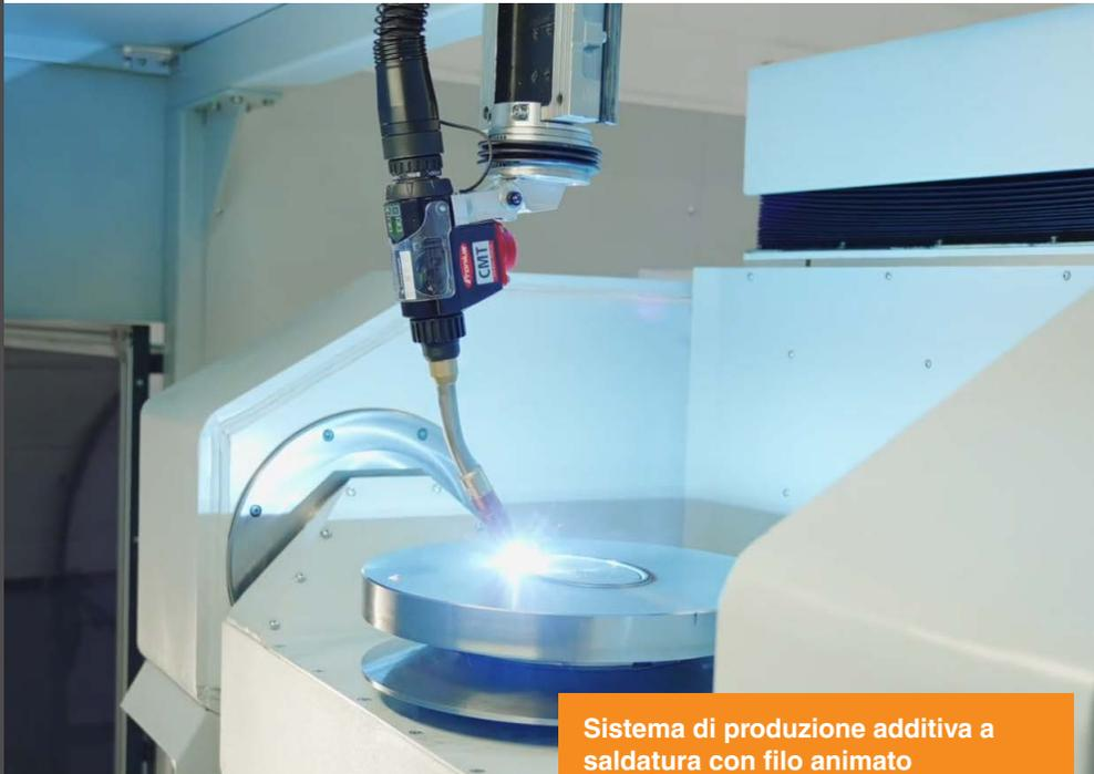
Sistema di produzione additiva a saldatura con filo animato
