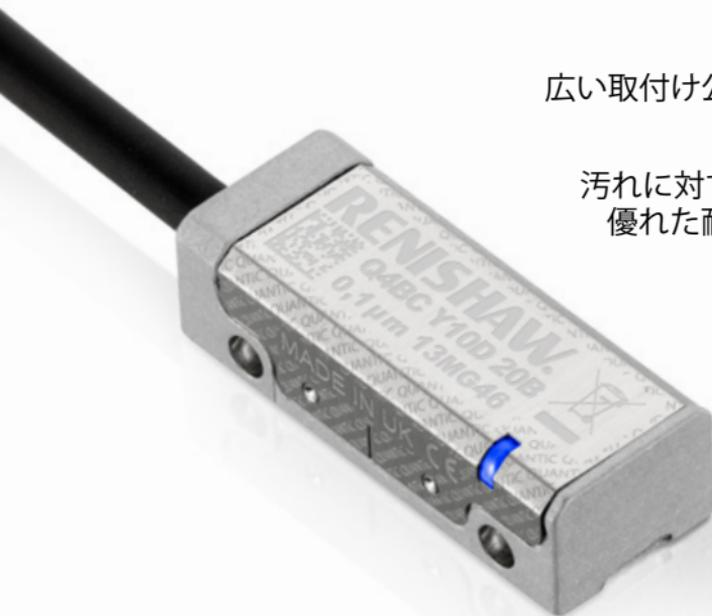
QUANTiC は、実績あるフィルタリング機構と内挿分割機構を小型ボディに集約したオープンタイプの光学式インクリメンタルエンコーダです。アナログタイプとデジタルタイプをラインナップしており、広い取付け公差とキャリブレーション機能が特徴です。取付け状態の最適化や現場でのトラブルシューティングに便利な高度診断ツール ADTi-100 および ADT View に対応しています。
