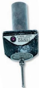
**自社初の製品の発売:** レニショーの TP1 タッチトリガープローブが市販され、三次元測定機による自動部品検査に革命を起こしました。
