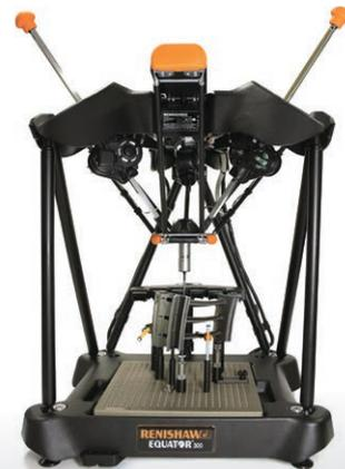
Equator の計測データをもとに工作機械コントローラのオフセットを直接更新し、クローズドループフィードバックによるプロセスコントロールを構築します。
