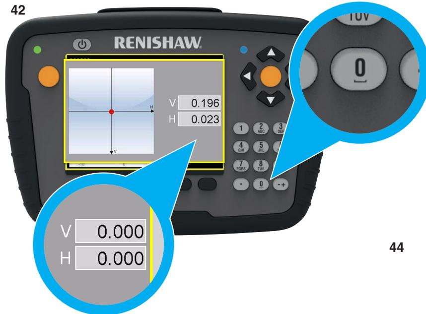
将**M装置**移至机器结构上最远的位置。
