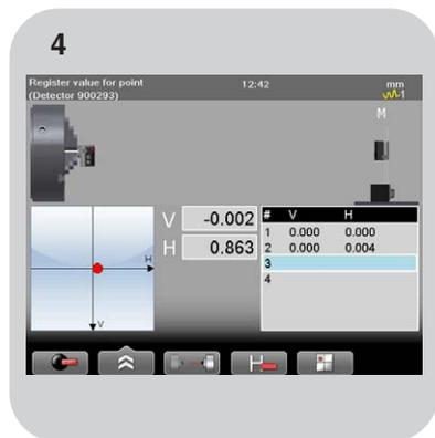
将M装置移至最远的测量位置, 并在第三个点采集数据。
