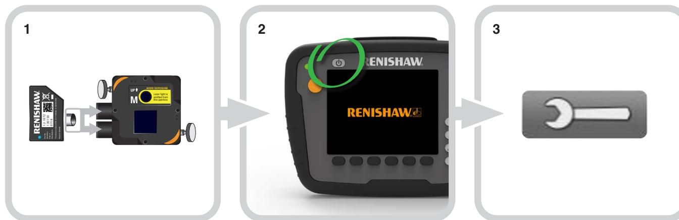
1 将无线模块插入M装置。
