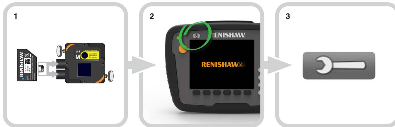
1 将无线模块插入M装置。
