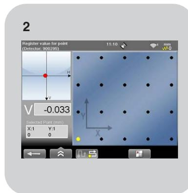
2 将探测器移至高亮显示的位置，然后旋转滑扫光束，直至光点距离PSD的中心在 $\pm 1$  mm以内。
