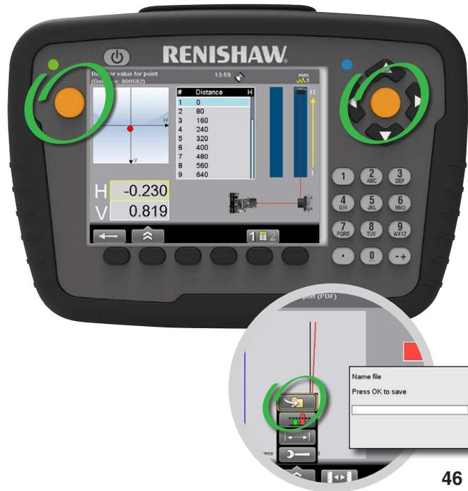
将M装置依次移至机器结构上的每个测量位置并按下橙色按钮采集误差，便可采集所有测量位置的数据。
