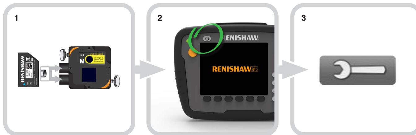
1 将无线模块插入M装置。
