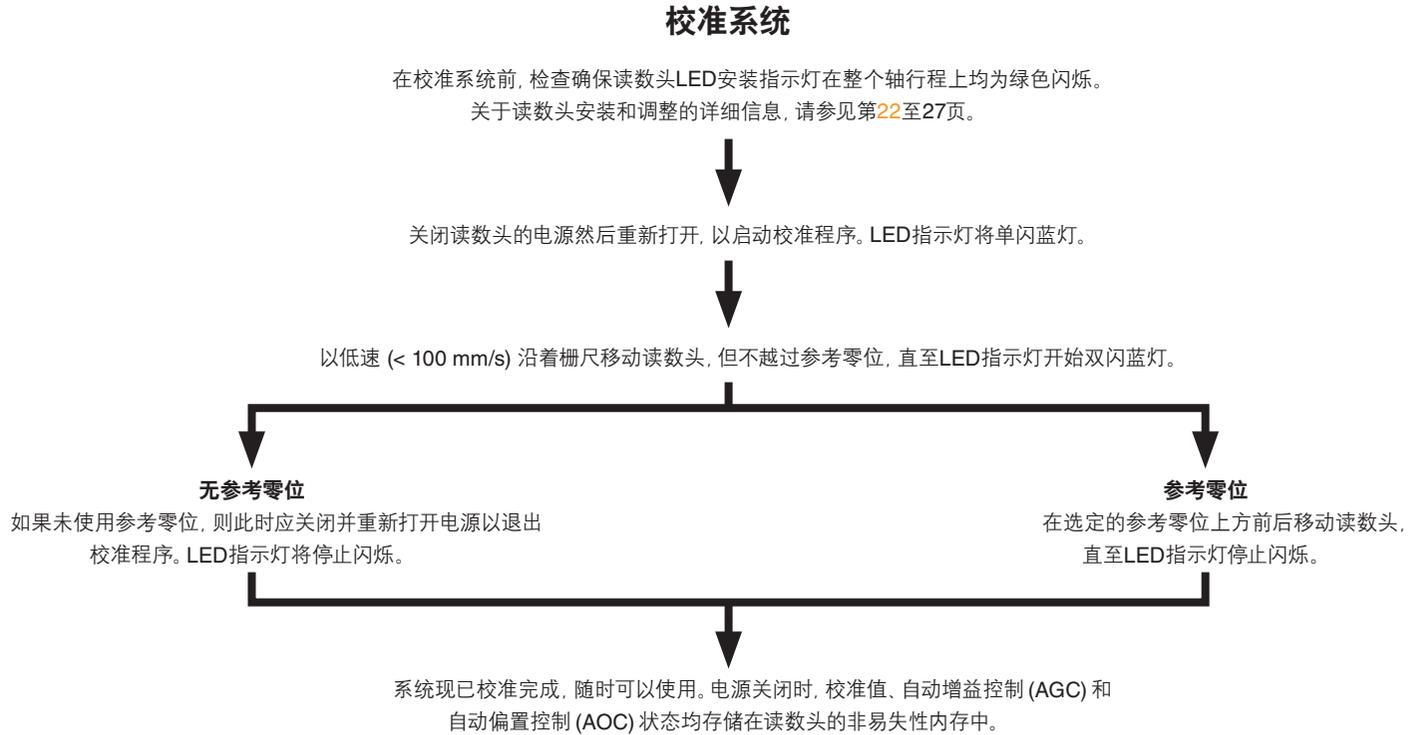
**注：**如果校准程序失败（读数头LED指示灯保持单闪蓝灯），则将读数头恢复为出厂默认设置（请参见第30页的“恢复出厂默认设置”），并重复安装和校准程序。
