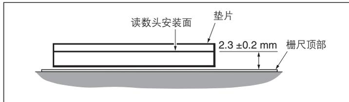
在读数头的安装面和支架之间插入已知厚度的垫片，以提供合适的间隙，即2.5 mm ( $\pm 0.2$  mm)。
