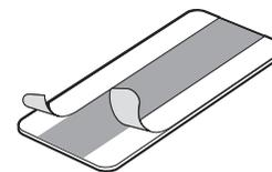
4. 立即将端压片放置在栅尺端部上方,并用力按压以确保粘牢。在20 °C下放置24小时,使粘合剂充分发挥作用。<sup>1</sup>
