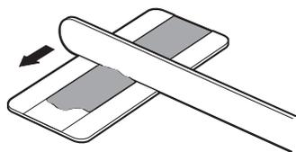
3. 端压片上带有两小块供涂抹接触型胶粘剂的区域,用于在环氧胶固化之前暂时将端压片固定到位。从任意一侧撕去背纸。
