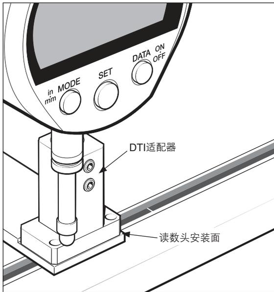
2. 将测得的距离减去2.5 mm的标称间隙, 即可计算出所需的垫片厚度。例如, 如果测得的距离为2.37 mm, 则所需的垫片厚度为130  $\mu\text{m}$ 。
