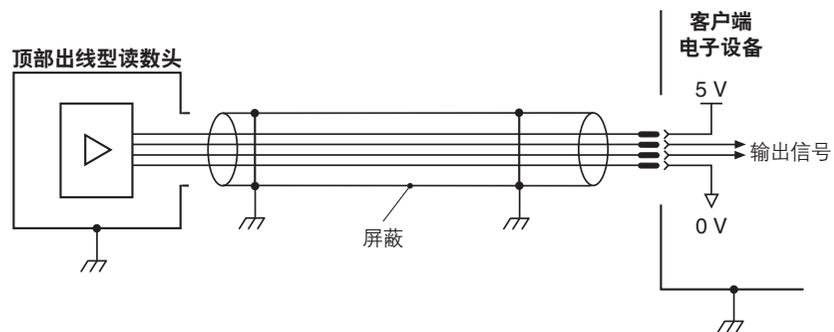
**重要提示：**屏蔽必须连接到设备地线上（励磁接地）。
