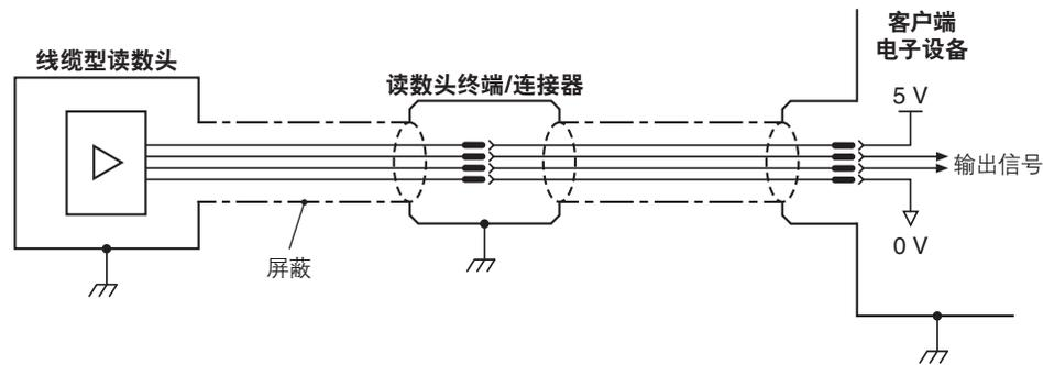
**重要提示：**屏蔽必须连接到设备地线上（励磁接地）。对于JST型号，线箍必须连接到设备地线上。
