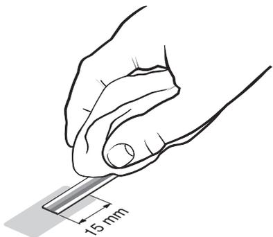
2. 将一小袋RGG-2双组分环氧胶粘剂充分摇匀,然后挤少量涂抹于端压片的底面。
