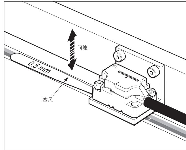
4. 拧紧支架固定螺钉, 同时确保支架、垫片与栅尺表面之间接触良好。
