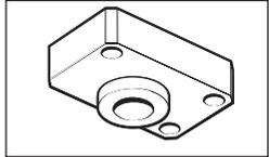
它可代替读数头直接安装在支架上。支架上应有一个定位销或台肩来控制读数头扭摆。关于支架设计的详细信息,请联系当地的雷尼绍业务代表。
