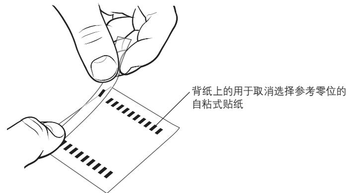
4. 将贴纸与栅尺上不需要的参考零位对齐（如下图所示），然后在安装工具薄膜上用力摩擦，直至贴纸粘到栅尺上。应小心进行，确保贴纸完全覆盖参考零位，且没有遮挡增量码道。
