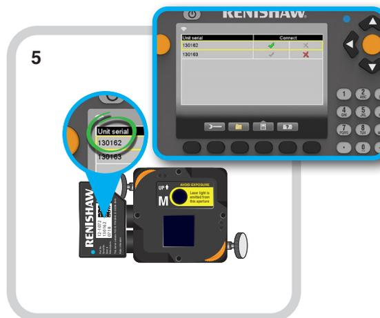
Attivare il dispositivo wireless connesso all'unità M.
