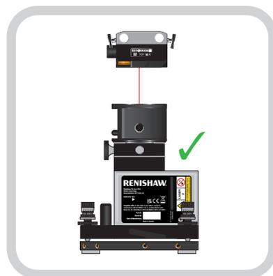
Regolare l'unità M fino a portarla in posizione perpendicolare rispetto al trasmettitore.
