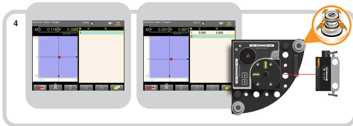
Selezionare "1/2" per dimezzare la lettura laser. Regolare il valore "V" su 0,00 utilizzando l'apposita vite (arancione).
