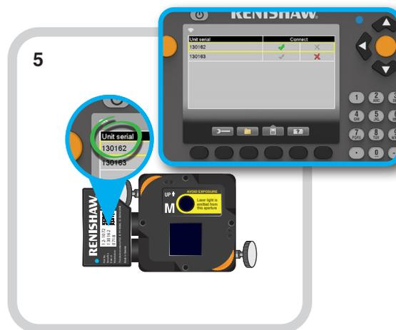
Attivare il dispositivo wireless connesso all'unità M.
