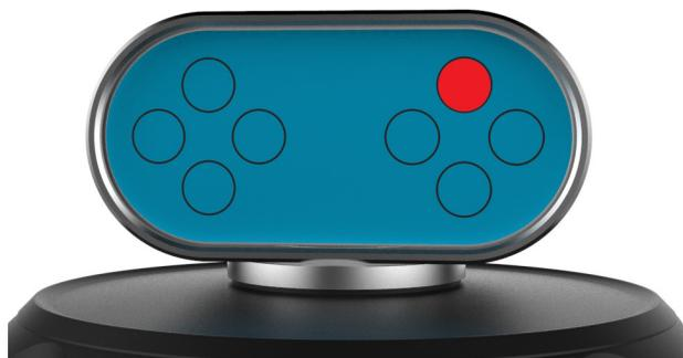
9. Per ridurre al minimo gli errori di misura, il laser deve essere allineato perpendicolarmente all'asse di rotazione della macchina. Per maggiori informazioni, vedere la sezione Errori di impostazione. Regolare il beccheggio del laser in modo che il fascio si rifletta su una linea orizzontale immaginaria che attraversa il centro dell'apertura di uscita dell'otturatore, come mostrato.
