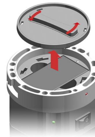
Durante l'inserimento di una batteria, assicurarsi che i terminali si trovino sopra e in corrispondenza di quelli del vano batterie.
