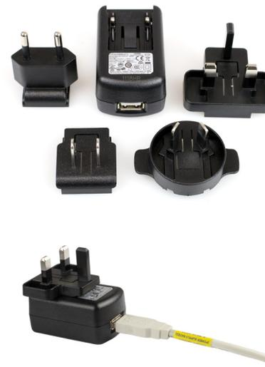
Assicurarsi che l'adattatore della spina compatibile con gli standard del proprio paese sia collegato al sistema di alimentazione USB. Spingere l'adattatore finché non è completamente inserito. Collegare il sistema di alimentazione USB alla porta USB dell'unità XR20 tramite il cavo USB (A-B) fornito. Collegare il sistema di alimentazione USB alla presa elettrica.
