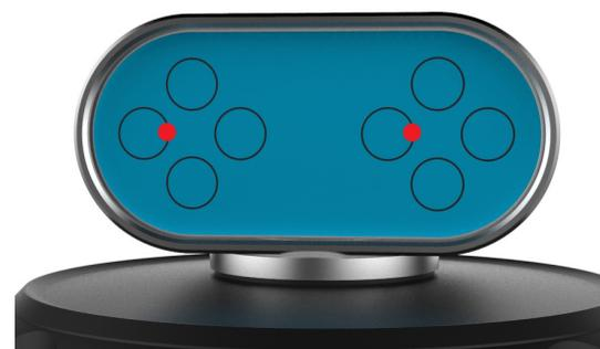
9. Se necessario, ruotare l'unità di trasmissione fino a quando i fasci non sono a livello con il bersaglio blu.
