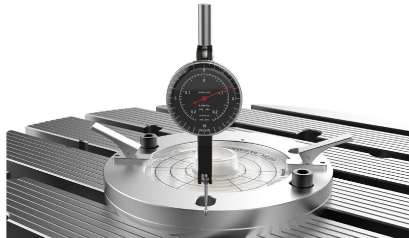
10. Dopo l'allineamento, fissare l'anello di montaggio all'asse, inserendo dei bulloni nei fori presenti nelle cave della macchina. Se le cave non dovessero passare sotto i fori di montaggio, potrebbe essere necessario utilizzare dei morsetti. Rimuovere la dima di centraggio.
