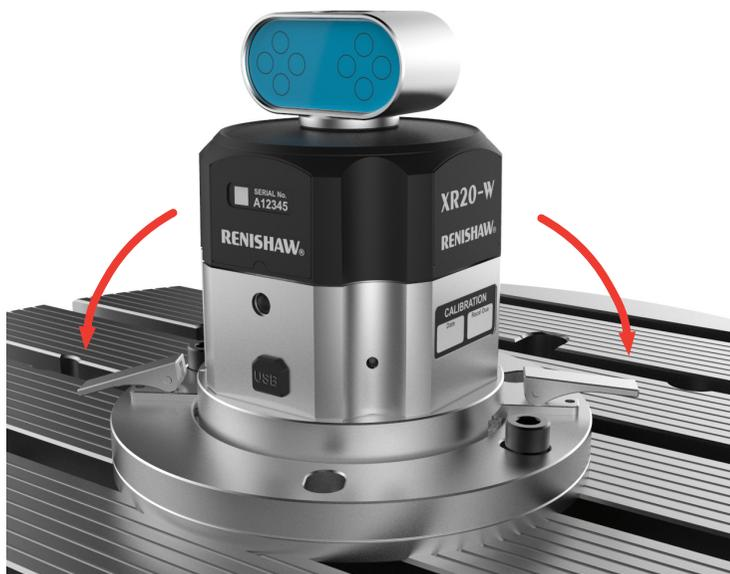
13. Chiudere le levette di fissaggio per fissare l'unità XR20.
