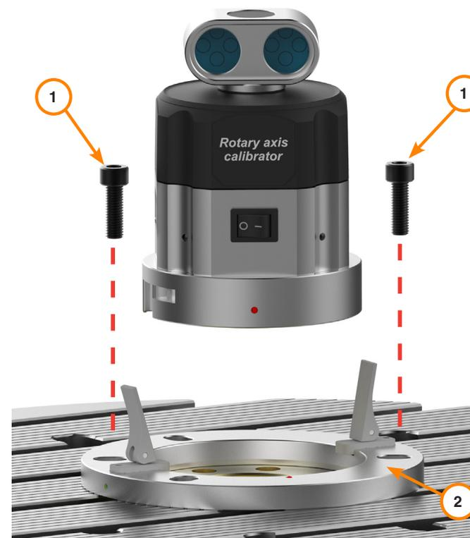
L'anello di montaggio viene fissato alla tavola con i bulloni inseriti nei fori di montaggio nelle cave della macchina.
