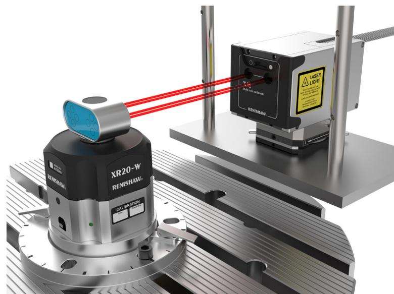
**AVVERTENZA:** Se il trasmettitore XM venisse montato su un treppiede, potrebbe produrre errori di misura.
