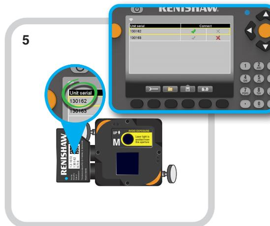
Active el dispositivo inalámbrico conectado en la unidad M.
