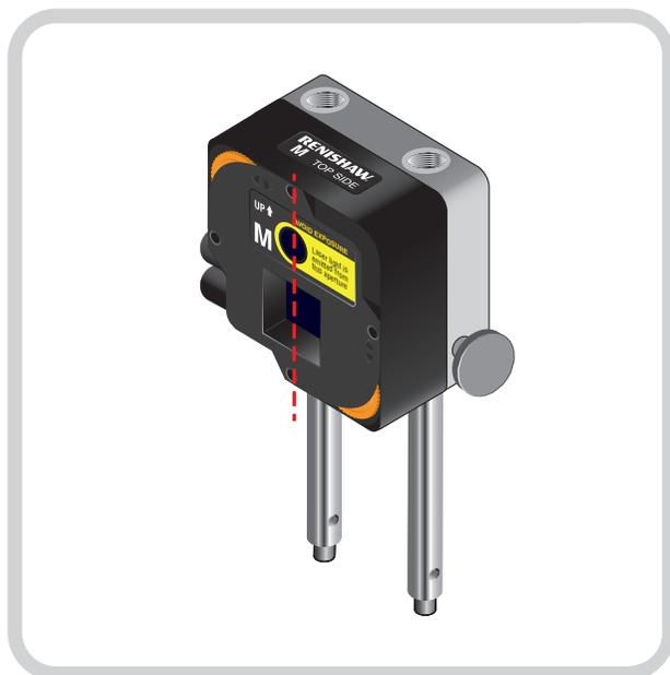
La configuración por defecto del modo de cuadratura mide las desviaciones sobre el eje vertical del PSD. Esta guía utiliza esta configuración.
