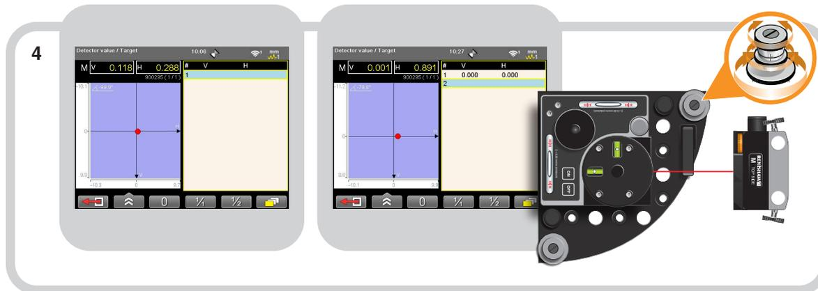
Seleccione "1/2" para reducir a la mitad la lectura del láser. Cambie el valor "V" a 0.00 mediante el tornillo de ajuste (naranja).
