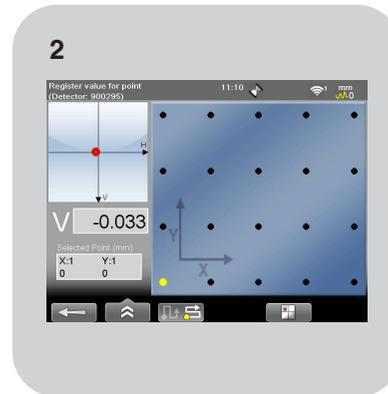
Mueva el detector a la posición resaltada y gire el haz de barrido a  $\pm 1$  mm del centro del PSD.
