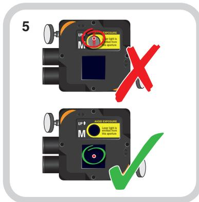
5 Ajuste la altura de la unidad M en los pilares, de forma que el haz quede alineado con el centro del PSD.
