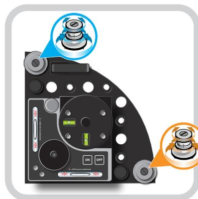
La placa de inclinación se ajusta mediante los controles de cabeceo y ladeo.
