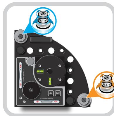
La placa de inclinación se ajusta mediante los controles de cabeceo y lado.
