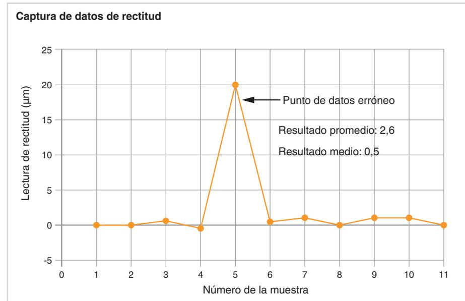
**NOTA:** El filtrado medio es la razón por la que puede obtener distintos resultados de rectitud al compararlos con interferómetros láser.
