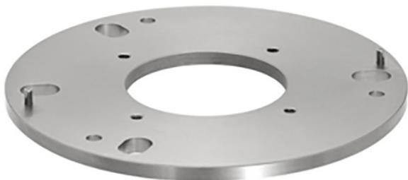
El plato adaptador del anillo de montaje permite ajustar el calibrador XR20 en mesas giratorias con tolerancias de centrado de difícil colocación. También sirve para sujetar el calibrador de ejes rotatorios XR20 en el adaptador del plato de garras y otras opciones de montaje a medida.
