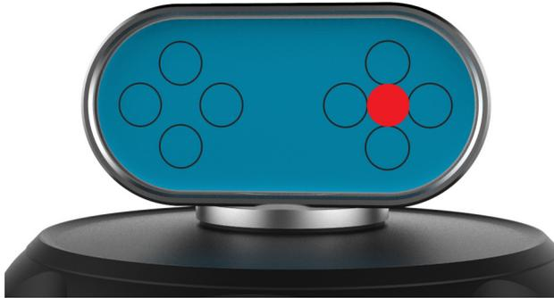
8. Desplace el calibrador XL-80 horizontalmente y verticalmente, de manera que el haz láser incida sobre el objetivo superior derecho de la ayuda de alineación, como muestra la imagen:
