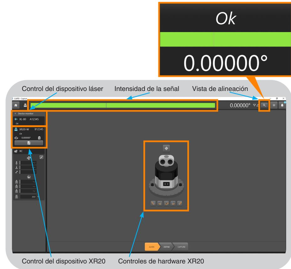
Quando se conecta el hardware se muestra la aplicación en la vista. Compruebe que el láser está conectado a la interfaz.
