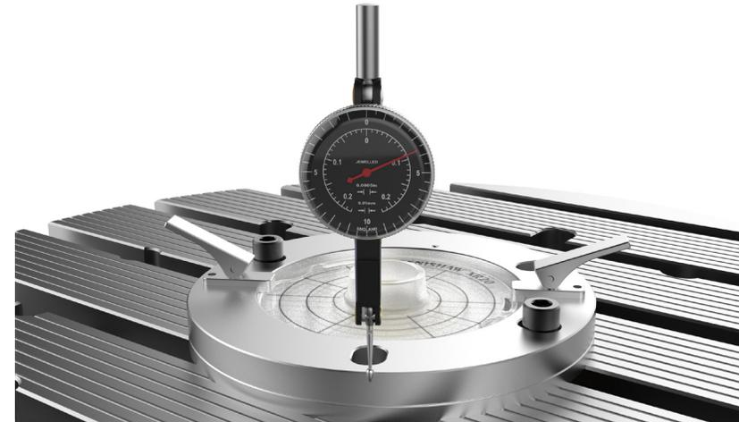
10. Una vez alineado, el anillo de montaje debe sujetarse al eje con pernos pasantes a través de los orificios de montaje de las ranuras en T. Si las ranuras en T no pasan por debajo de los orificios de montaje, deberán utilizarse patas de sujeción. Retire la ayuda de centrado.
