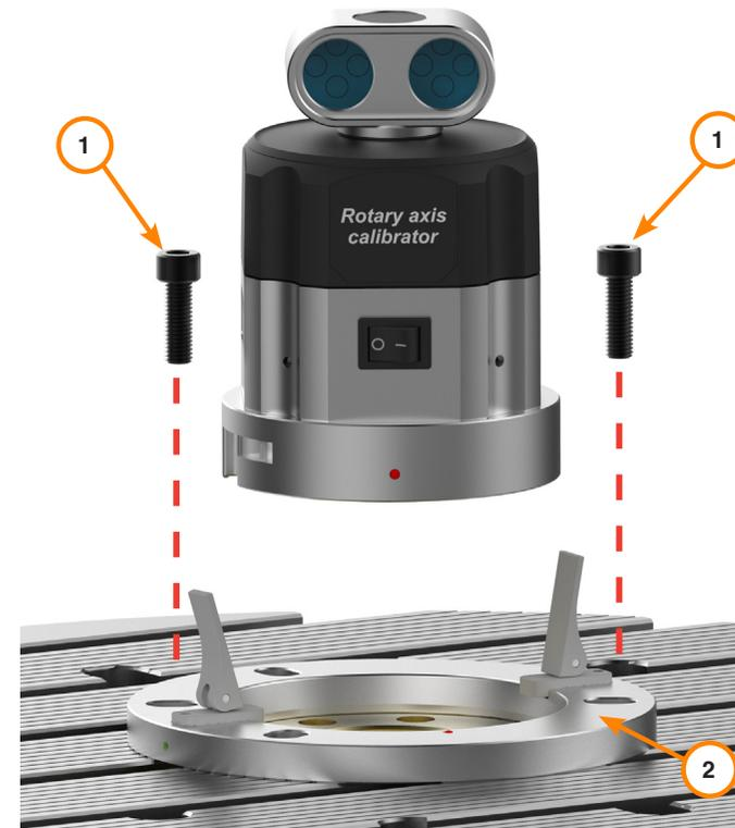
El anillo de montaje externo debe sujetarse a la mesa con pernos pasantes a través de los orificios de montaje de las ranuras en T.
