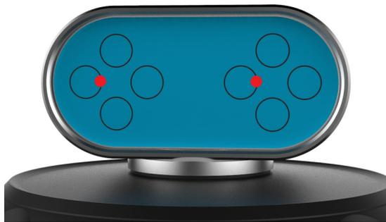
3. Observe el haz reflejado en el bloqueador del haz de la unidad emisora. Ajuste el paso de la unidad emisora hasta que el haz reflejado quede en la línea central.
