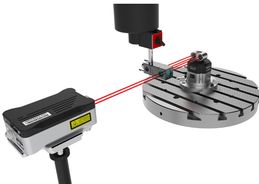
圖 1 使用 XL-80 作為雷射基準來校準旋轉軸的一般設定
