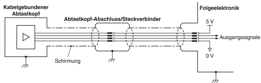
**WICHTIG:** Der Schirm sollte mit der Maschinenerde (Feldmasse) verbunden werden. Für JST-Varianten sollte der Kabelschutz mit der Maschinenerde verbunden werden.
