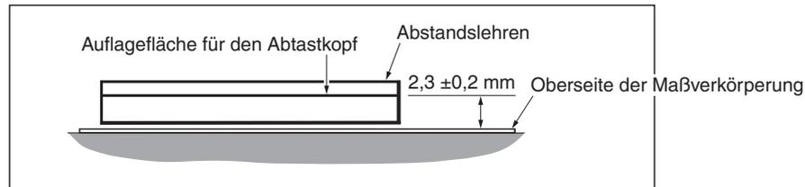
Abstandslehren bekannter Stärke werden zwischen die Montagefläche des Abtastkopfes und die Halterung eingesetzt, um den richtigen Abstand von 2,5 mm ( $\pm 0,2$  mm) zu erreichen.
