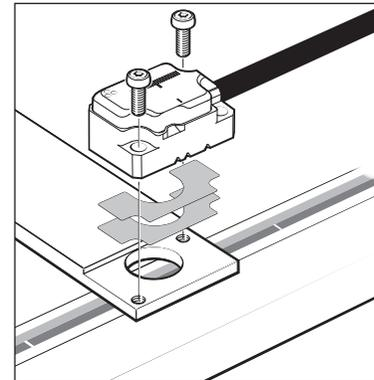
6. Verbinden Sie den Abtastkopf mit der Empfangselektronik und schalten Sie das System ein.
