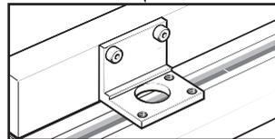
Referenzkante des Abtastkopfes an einer Anschlagkante
