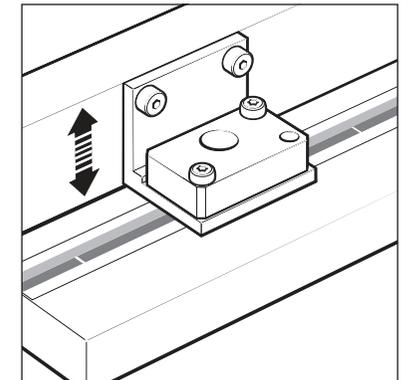
3. Verstellen Sie die Höhe der Halterung, bis die „Nase“ des Abtastkopf-Dummys das Maßband leicht berührt.
