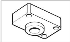
Dieser Dummy wird anstelle des Abtastkopfes direkt auf der Halterung montiert. Die Halterung sollte über Positionsstifte oder eine Führungskante zur Kontrolle des Abtastkopf-Gierwinkels verfügen. Für weitere Informationen zur Konstruktion der Halterung kontaktieren Sie bitte Ihre Renishaw-Niederlassung.
