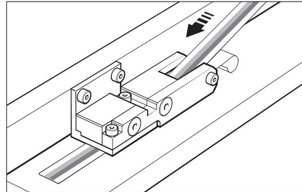
8. Drücken Sie das Maßbandende mithilfe eines sauberen, trockenen, faserfreien Tuches mit den Fingern fest, um sicherzustellen, dass es gut auf dem Untergrund haftet.
