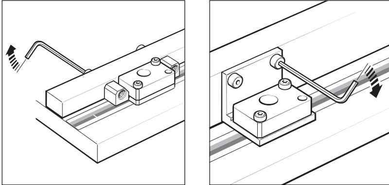
5. Entfernen Sie den Abtastkopf-Dummy.
