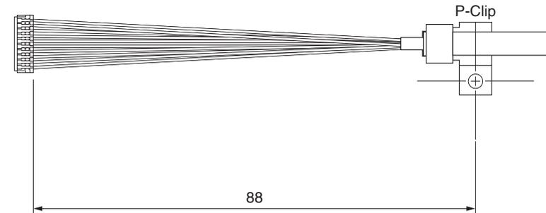
Detail B: P-Clip Abmessungen
