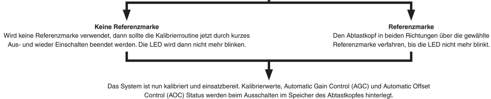
**HINWEIS:** Sollte die Kalibrierung fehlschlagen (die Abtastkopf-LED blinkt weiterhin einzeln blau), stellen Sie die Werkseinstellungen des Abtastkopfes wieder her (siehe 'Wiederherstellen der Werkseinstellungen' auf Seite 32). Wiederholen Sie dann die Installation und Kalibrierroutine.
