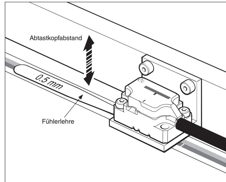
4. Ziehen Sie die Schrauben an, solange der Abtastkopf die Abstandslehre auf die Maßverkörperung drückt.
