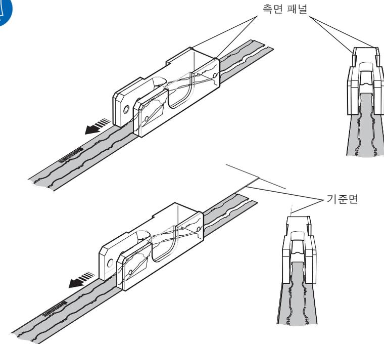
6. 스케일이 아래 그림과 같이 프로젝션 아래에 위치하는지 확인하면서 RTL40 스케일을 *FASTRACK* 캐리어로 밀어 넣으십시오. RTL40 스케일은 *FASTRACK* 캐리어에서 당기거나 밀어 수동으로 설치할 수 있습니다. 또한 아래 그림과 같이 선택 품목인 RTL 스케일 설치 공구를 사용하십시오.
