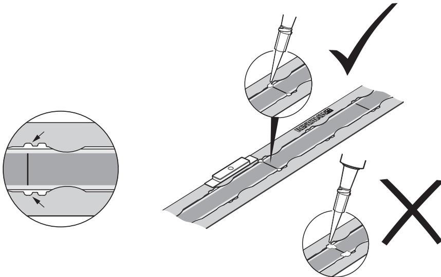
**주:** 확실한 고정을 위해 이러한 영역에만 **Loctite 435**를 바르십시오. 모재에 고정시키기 위해 **Loctite 435**가 스케일 아래에 스며듭니다.
