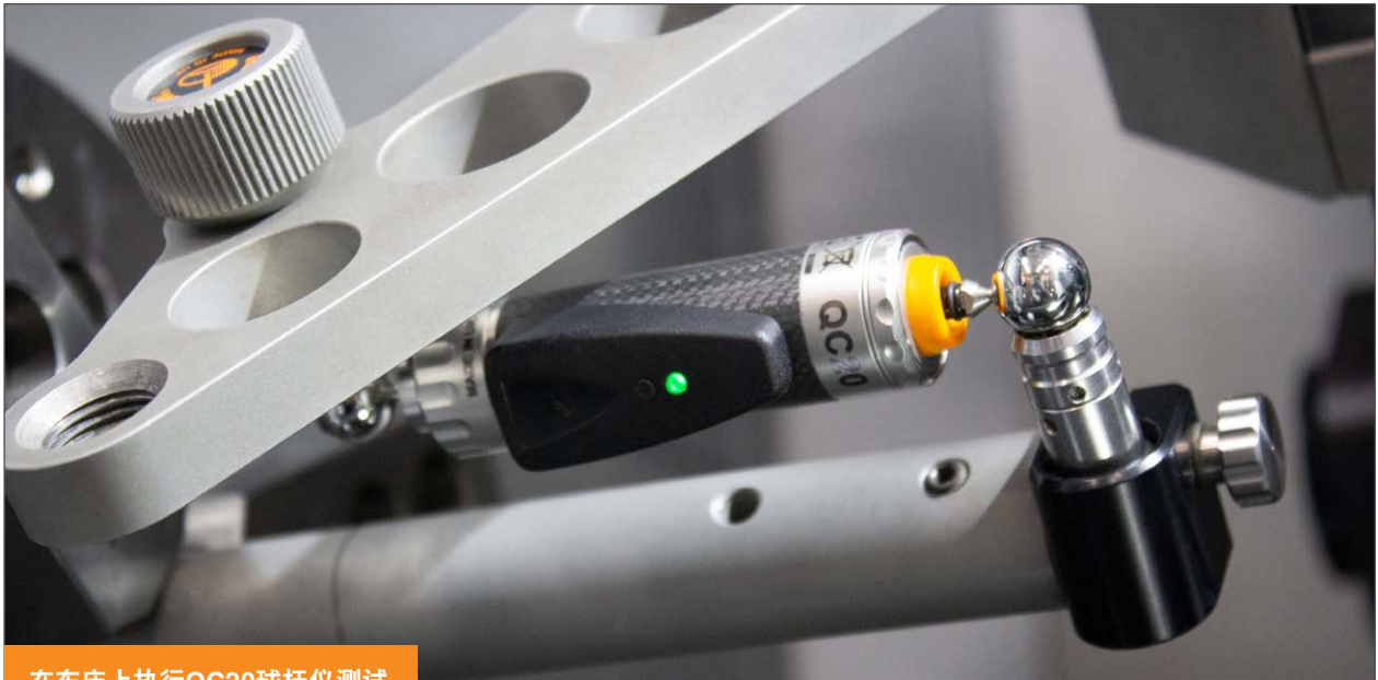
在车床上执行QC20球杆仪测试
