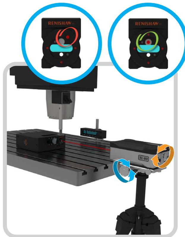
使用激光器上的俯仰和扭摆调节旋钮进行准直, 使光点落在白色光靶的中心。
