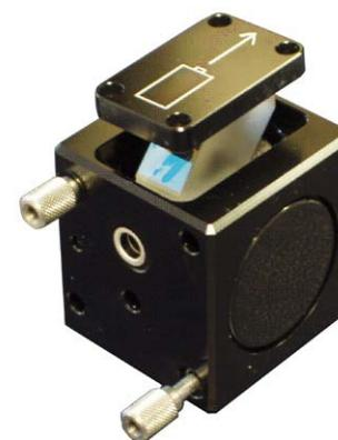
重新组装时，在完全拧紧内六角螺钉之前，确保光学镜滑架对准外壳的其中一个长边。这样可确保光学元件在外壳内正确对准。
