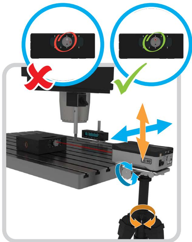
平移激光器，直至光点落在光学直角尺上安装白色光靶的中心。
