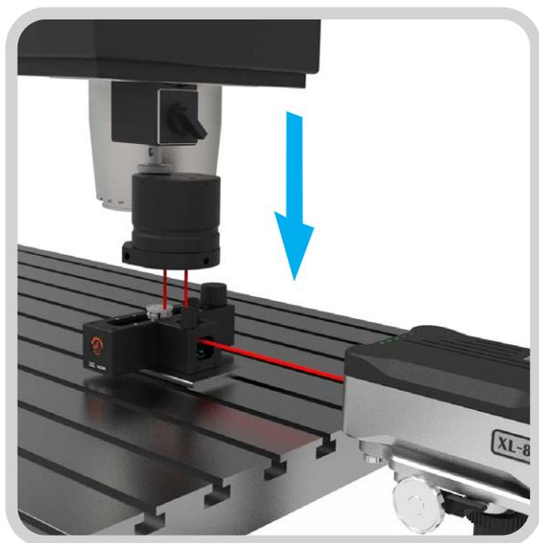
当激光光束在轴行程上限位置对准光靶时，将主轴尽可能靠近直线度基版组件。
