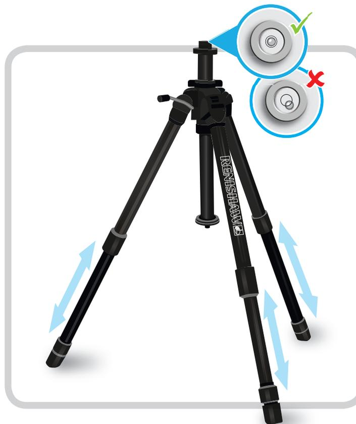
调整三脚架支脚, 以确保气泡位于水平位置。
