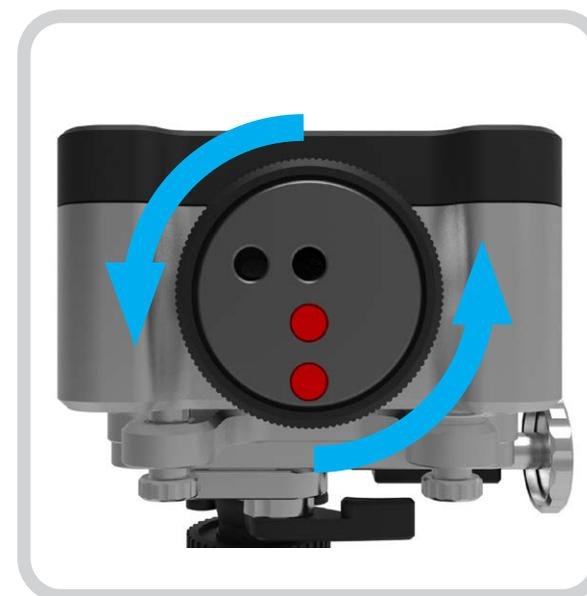
旋转直线度光闸的黑色边框，直至大光孔打开，且射出 6 mm 光束。
