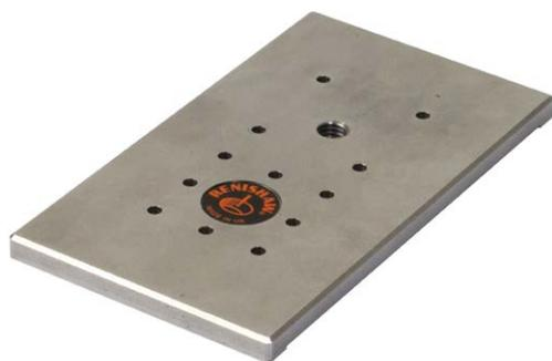
直线度基板用于安装直线度反射镜和垂直转向镜（或配有固定转向镜的激光准直辅助镜），以便沿垂直轴进行直线度测量。
