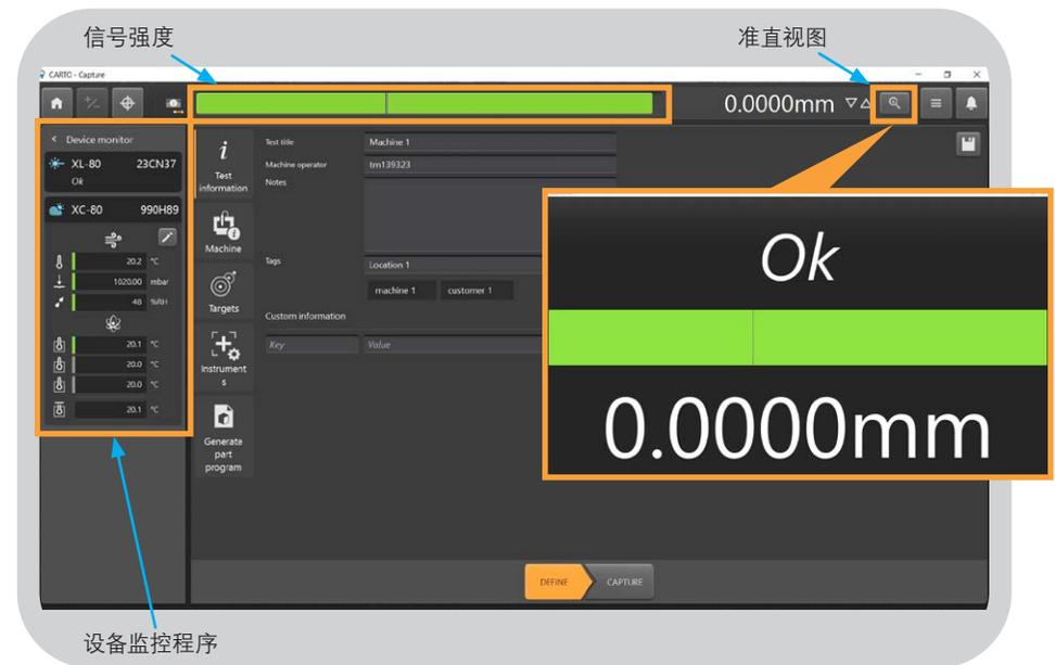
该应用程序将以图示视图打开。请确保XL-80和XC-80已连接至计算机。
