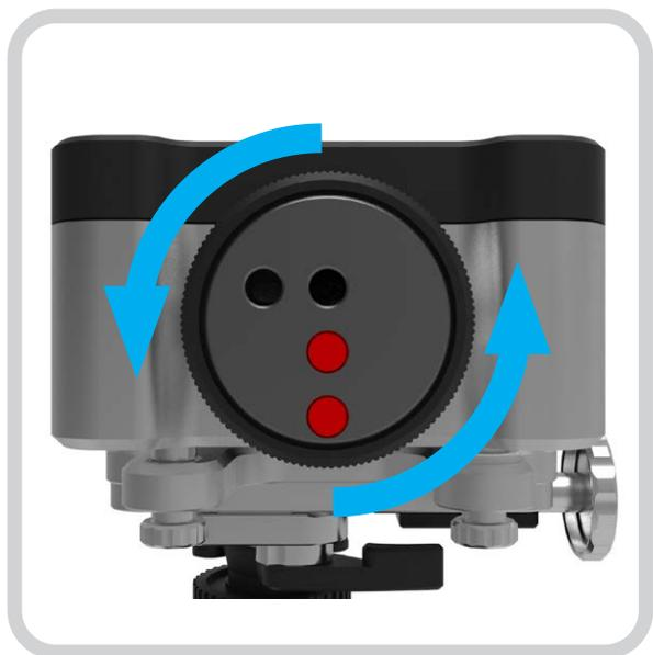
旋转直线度光闸的黑色边框, 直至大光孔打开。
