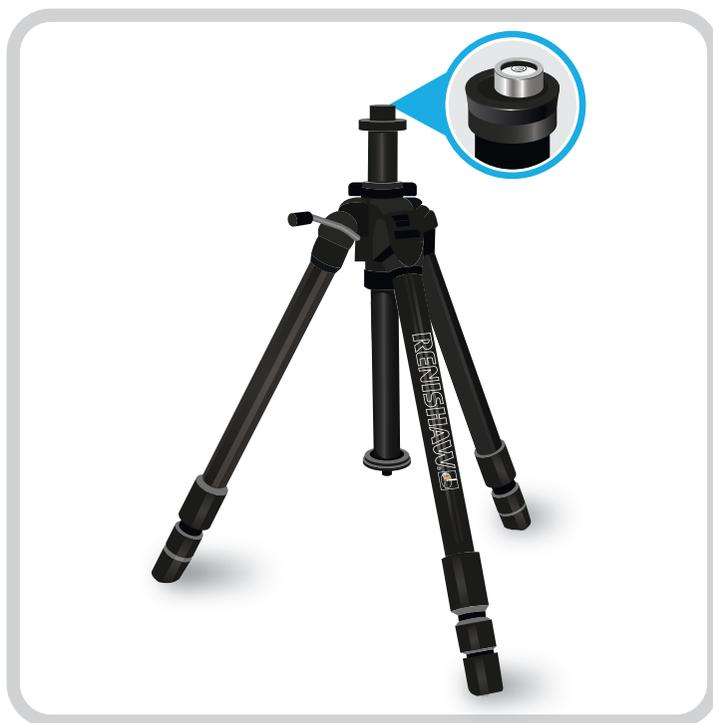
将气泡水平仪放在三脚架顶板上。
