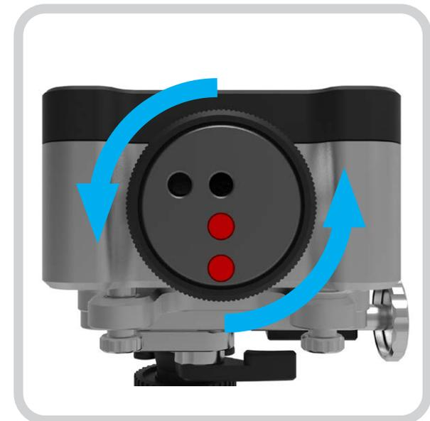
驱动主轴沿着整个轴行程移动，同时观察激光光束落在直线度光闸上的位置。如果发生准直偏差：
