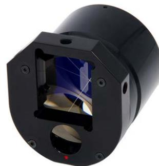
大角锥反射镜用于测量垂直轴的直线度。在某些水平方向直线度测量配置中, 当无法将静止的直线度反射镜放置在干涉镜后面时, 也可以使用大角锥反射镜。
