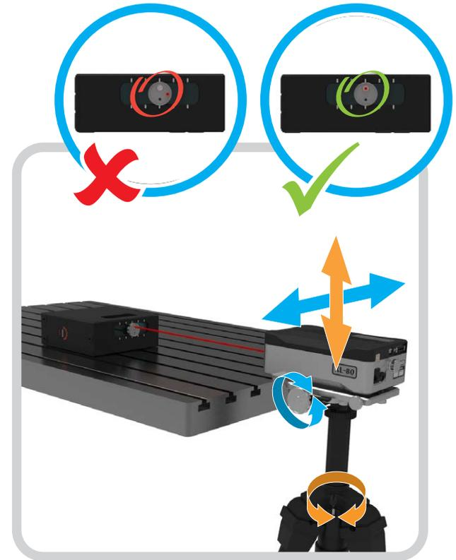
使用平移调节旋钮将光束调至白色光靶的中心。
