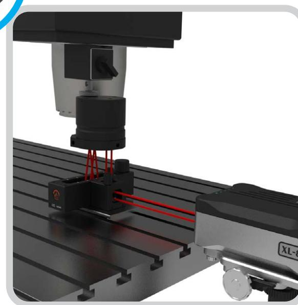
重复前面三个步骤，直至在整个轴行程上，激光光束始终落在白色光靶的中心。
