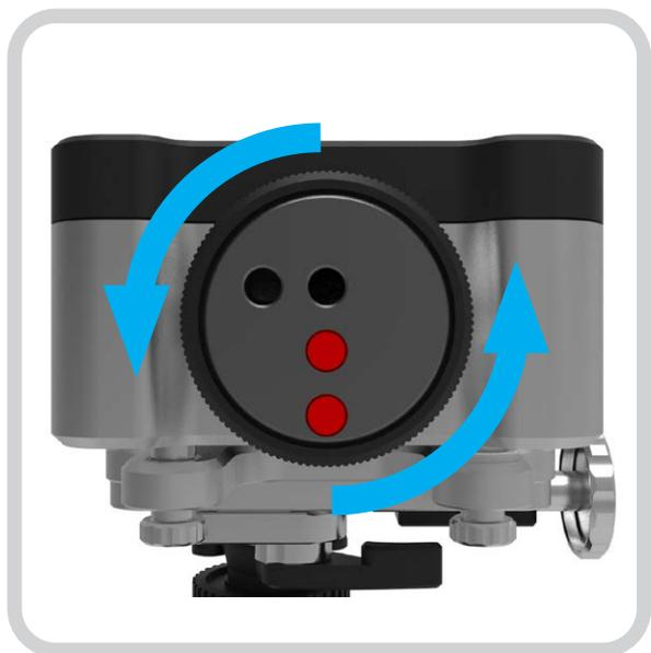
旋转直线度光闸的黑色边框，直至大光孔打开。沿整个轴行程检查信号强度。
