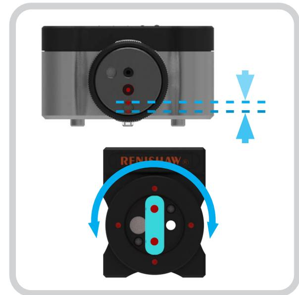
旋转直线度干涉镜，直至两条光束在直线度光闸的正面重叠。
