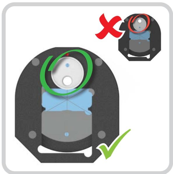
按照图示方向将光靶安装在大角锥反射镜的入射光孔上。
