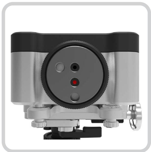
旋转激光器光闸的黑色边框，直至射出直径缩小的光束。
