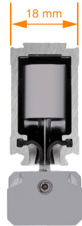
圖 3. FORTiS-S 和 FORTiS-N 光學尺殼體的縱切面，顯示了非接觸式讀頭的方向
