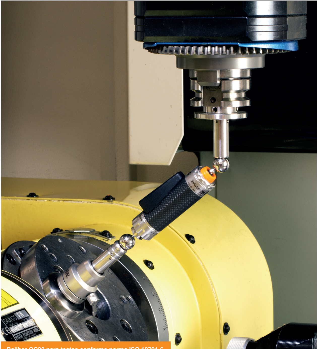
Ballbar QC20 para testes conforme norma ISO 10791-6
