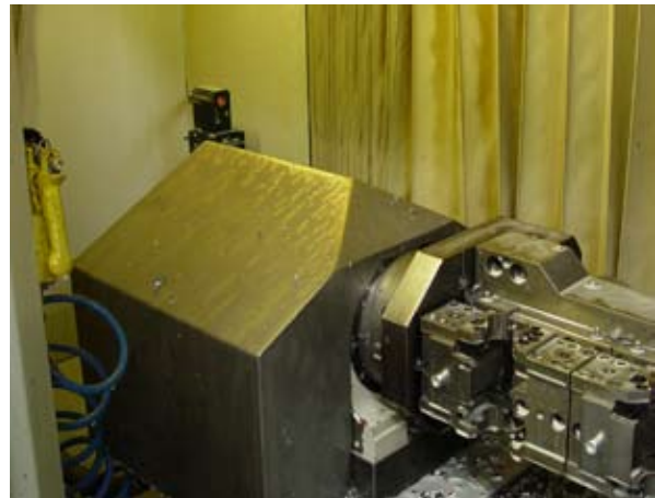
Renishaw contactloos lasersysteem, gemonteerd buiten het werkbereik van de machine
