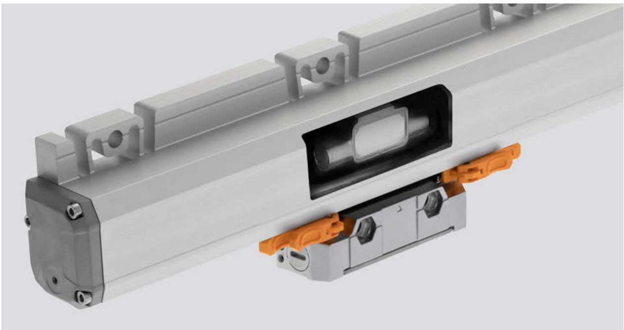
Abbildung 2b: FORTiS-S Messsystem in geschlossener Bauweise mit Ausschnitt, der die berührungslose, geschützte Abtastkopfeinheit in ihrem Gehäuse zeigt.
