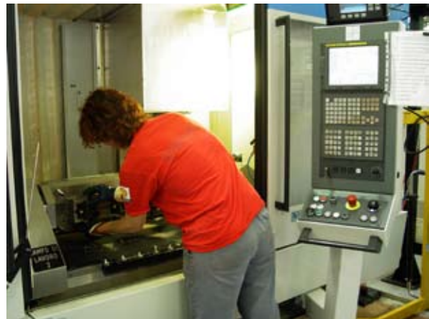
Jeden operator może z łatwością obsługiwać obie obrabiarki – wystarczy ładować przedmioty obrabiane i sprawdzać, czy wszystko przebiega płynnie
