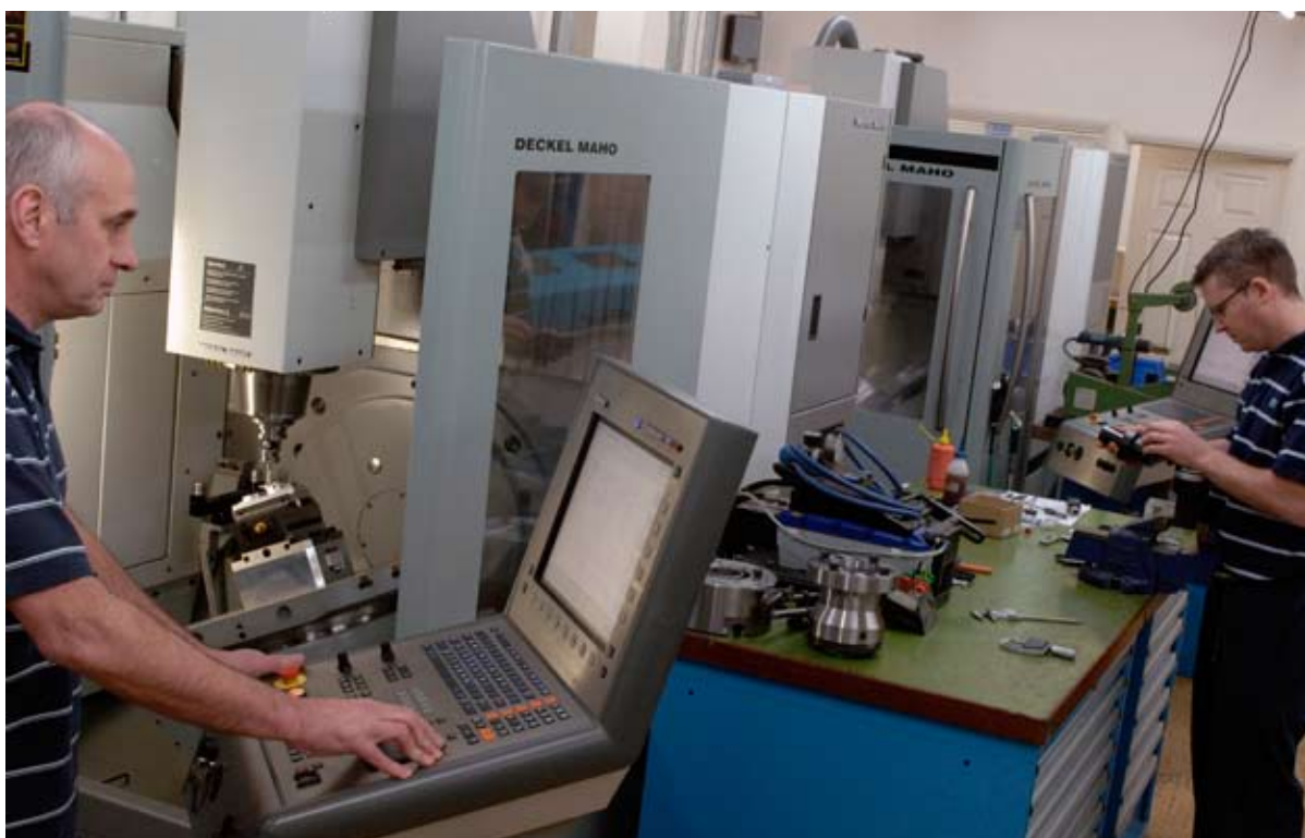
Przedmioty obrabiane ładuje się na obrabiarki DMG DMU-50 na małych paletach i konieczne są wielokrotne zmiany narzędzi
