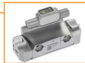
FORTiS光栅采用两个调谐质量阻尼器(TMD)来抵消垂直轴和水平轴上的振动。
