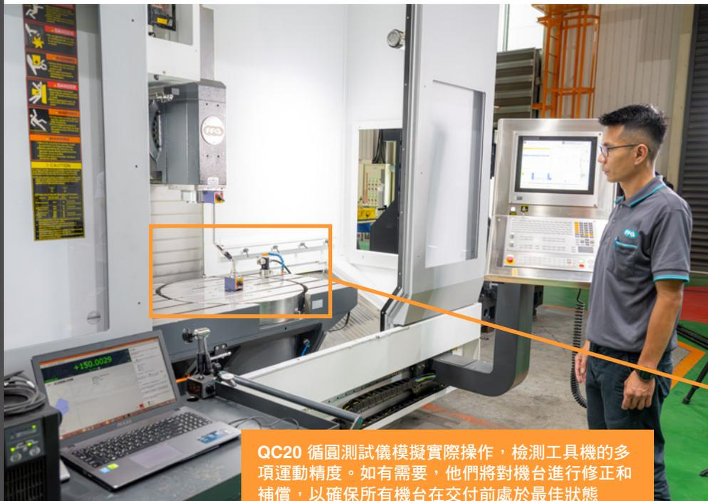
QC20 循圓測試儀模擬實際操作，檢測工具機的多項運動精度。如有需要，他們將對機台進行修正和補償，以確保所有機台在交付前處於最佳狀態
