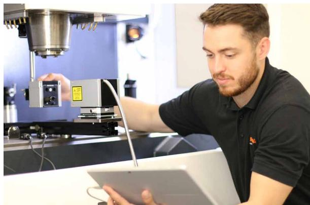
由於 XM-60 的單一線性軸量測可同時量測並解析 6 個自由度誤差，有別於傳統量測方法，測試結果可立即在 CARTO 軟體整合，根據 ISO 標準規範如 10791-2 (2023) 等進行誤差分析及比對，並生成客製化的報告，方便分享。
