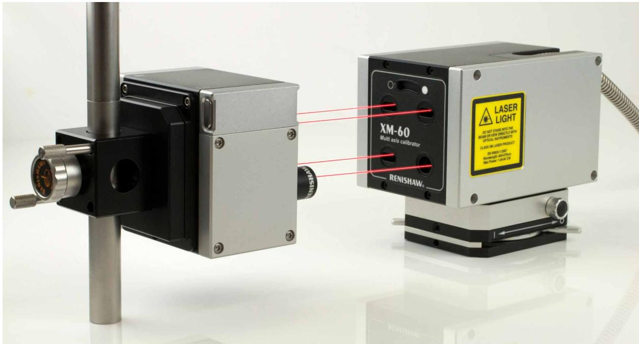
工具機在組裝時會因為多項原因產生誤差，所以廠家一般也會根據 ISO 國際標準規範要求，對線性軸的位移、直度和角度共 21 項誤差進行幾何量測，以及數控軸的定位精度和重複性。
