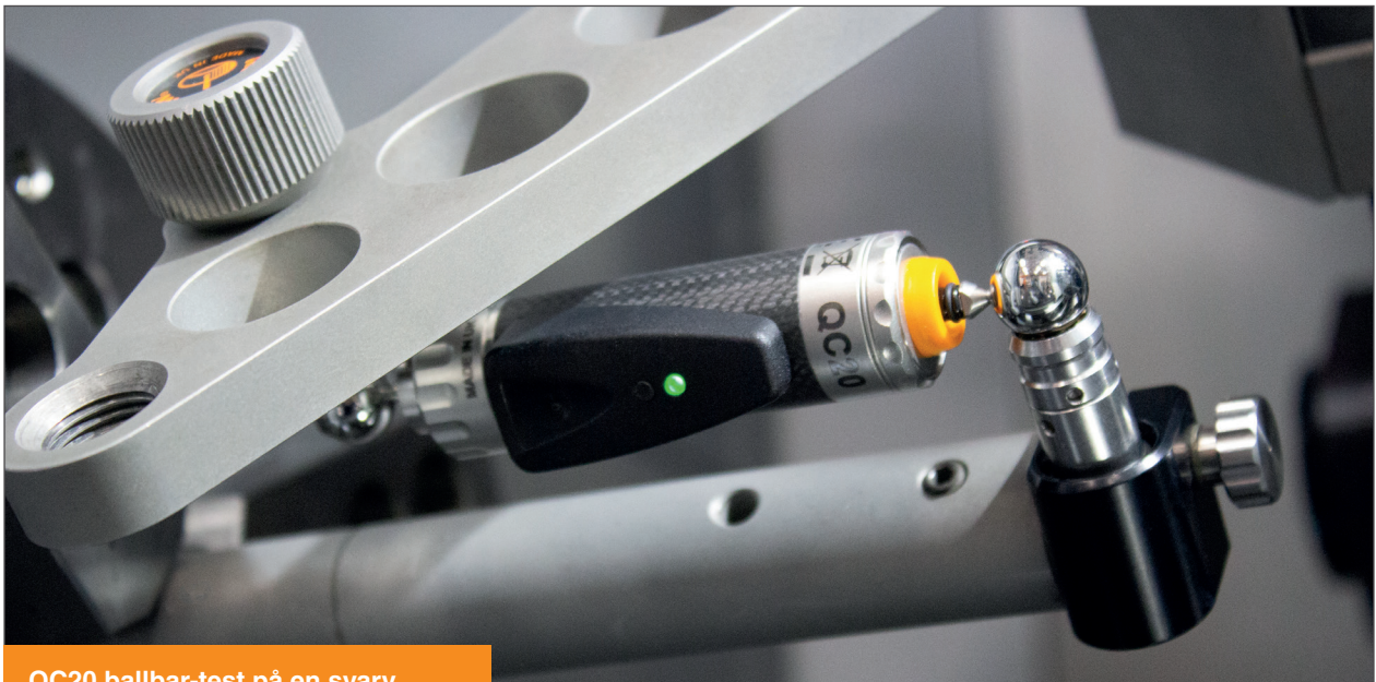
QC20 ballbar-test på en svarv
