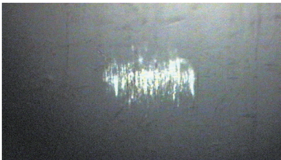
Na této rubínové kuličce je zřetelně vidět hliníkový povlak.
