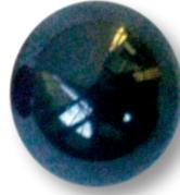
Uma cerâmica muito dura e resistente ao desgaste que pode ser usinada em esferas de alta precisão. Também pode ser polida até atingir um acabamento superficial extremamente liso. Suas aplicações são mais limitadas ao alumínio.
