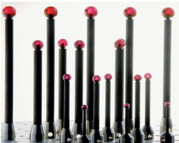
Pequenas diferenças de temperatura podem causar erros de medição. Você pode minimizar esses erros, escolhendo o material correto para a haste da ponta ou extensão.
