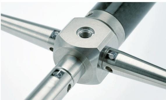
As articulações devem ser extremamente estáveis e usinadas com exatidão para garantir que a força de medição não altere a posição da extremidade da ponta durante a medição. A qualidade do projeto e dos materiais é vital.
