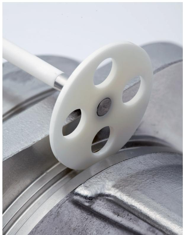
O disco requer calibração para apenas um diâmetro, mas isso limita a medição às direções X e Y somente. A adição de um pino permite que seja efetuado o referenciamento e portanto a medição na direção Z, desde que o centro do pino se estenda para além do diâmetro do palpador. O pino pode ser referenciado em uma esfera ou bloco padrão. Girando e fixando o disco ao redor do seu centro permite que o pino seja posicionado para adequar-se à aplicação.
