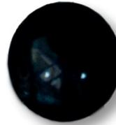
As esferas de cerâmica são revestidas com diamante até uma espessura de aproximadamente 0,015 mm e são em seguida polidas em um processo altamente complexo. Esferas revestidas com diamante manterão a sua circularidade e não sofrerão acúmulo de material ou desgaste prematuro ao escanear uma peça.
