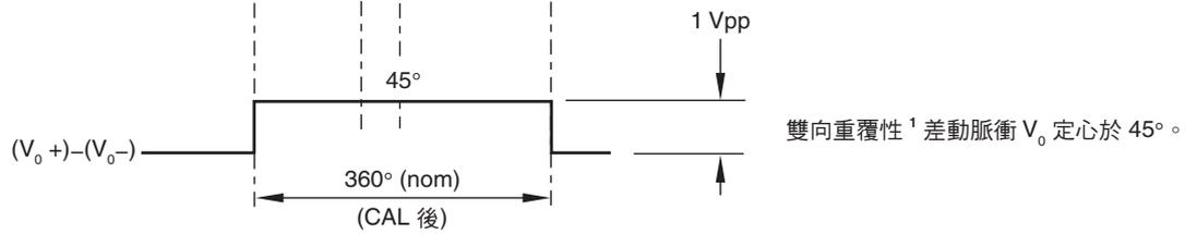
差分訊號  $V_{0+}$  和  $V_{0-}$  集中於  $\sim 1.65\text{ V}$ 。
