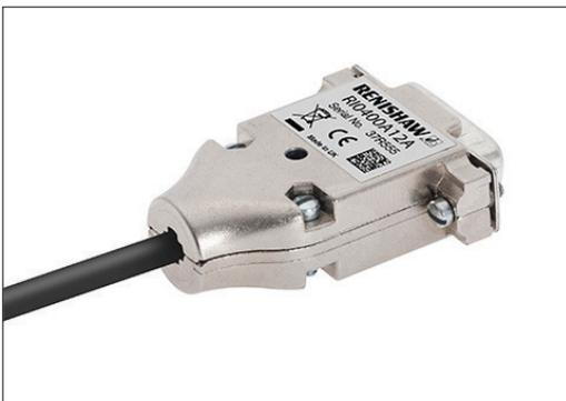
**Ri** 介面封裝於產業標準的 15 向 D 型連接器殼內，包括 CAL 按鈕。提供精細至 50 nm（時脈）及 0.5 µm（非時脈）的數位細分。另提供類比版本。
