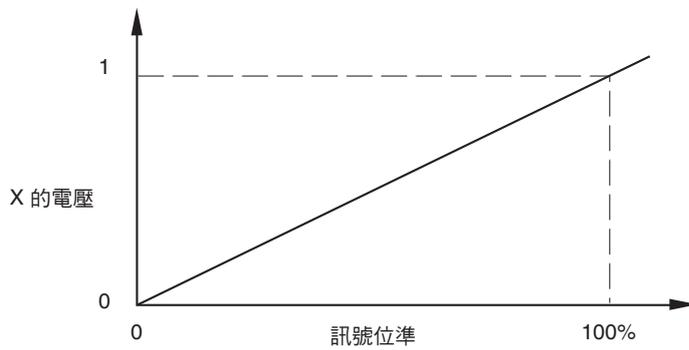
設定訊號電壓與增量訊號振幅成比例。
