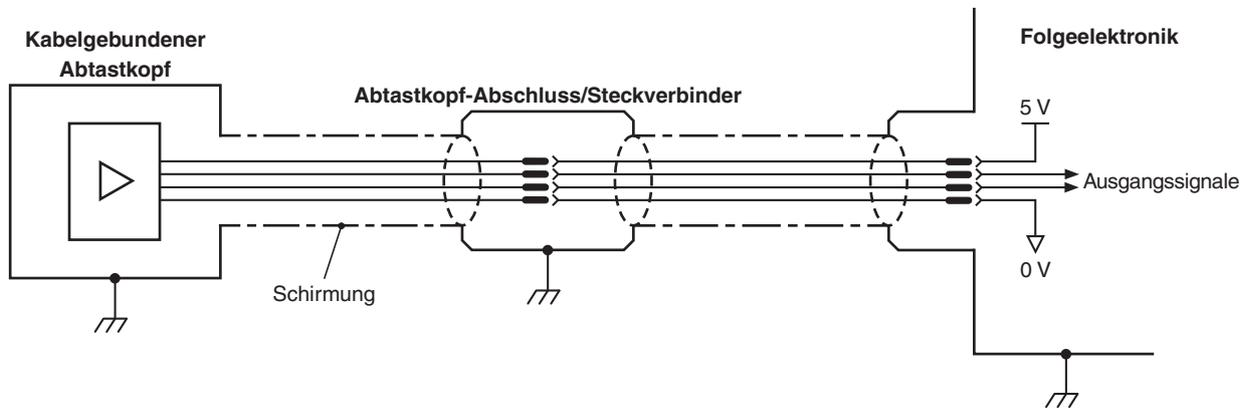
**WICHTIG:** Der Schirm sollte mit der Maschinenerde (Feldmasse) verbunden werden. Für JST-Varianten sollte der Kabelschutz mit der Maschinenerde verbunden werden.
