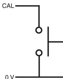
Die Fernkalibrierung (CAL) des Systems ist über den CAL-Pin möglich.
