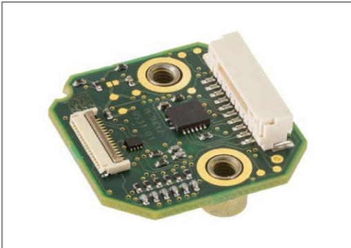
**ACi**接口是一系列开放的高性能微型细分器子系统。对于今天的运动系统而言，既要求高分辨率与高速性能相结合，又要求结构紧凑、格式开放、空间占用少、具有系统校准功能，同时要求高性价比，ACi接口对于此类系统则具有显著的优势。数字信号经细分后分辨率可达10 nm，时钟输出可达40 MHz。提供FPC和电缆两种输入类型。
