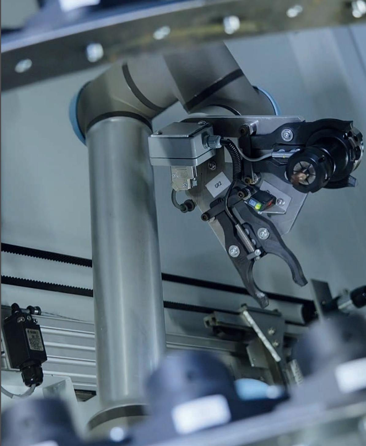
Effective CNC의 혁신적인 접근 방식은 기계 형식과 공구에 그치지 않았습니다. 새로운 공구 교환 로봇 또한 개발되었습니다. Pearson은 “우리는 복잡한 공구 교환 구조를 가진 직교 로봇을 제작하는 대신 협동 로봇라는 기성 솔루션을 선택하기로 결정했습니다.” 라고 덧붙였습니다.
