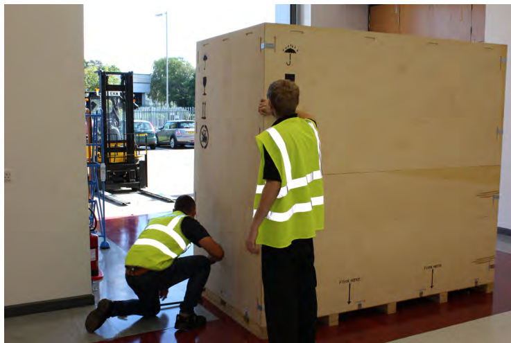
Abbildung 50 Halten und die Befestigungsklammern der Seitenplatte entfernen
