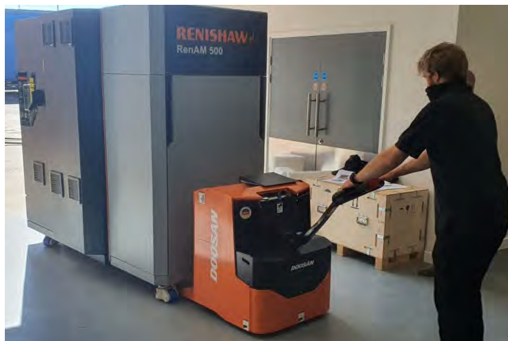
Abbildung 65 Das System mit einem Elektro-Hubwagen transportieren
