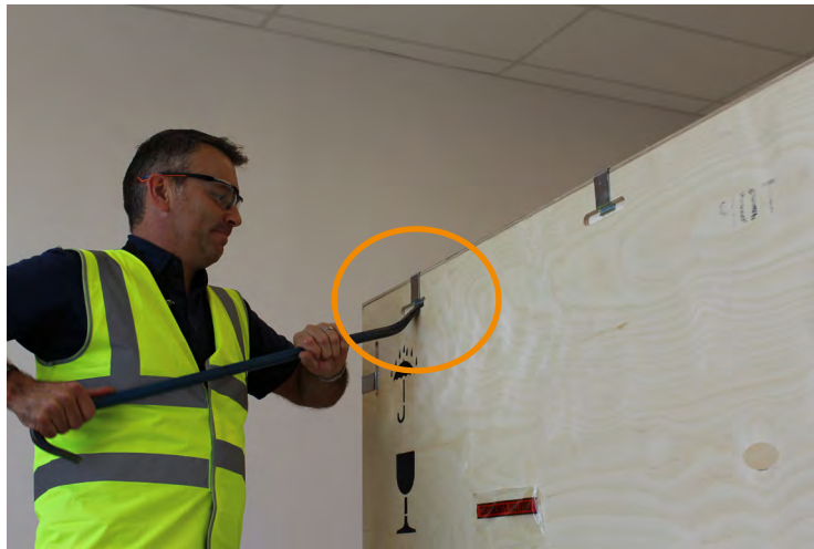
Abbildung 45 Die Befestigungsklammern am Deckel entfernen
