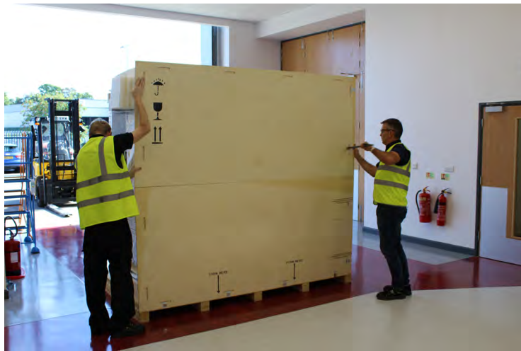
Abbildung 51 Halten und die Befestigungsklammern der hinteren oberen Platte entfernen
