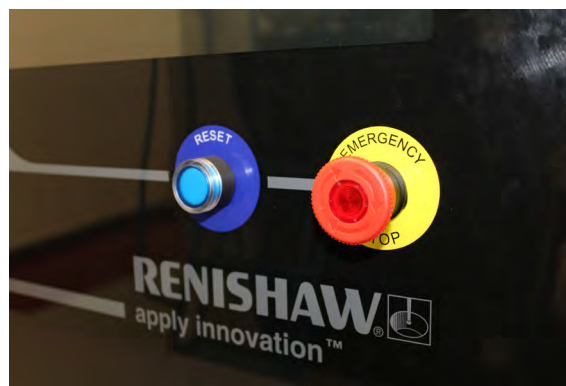
Abbildung 4 Not-Aus-Taste an der Frontseite des Systems der RenAM 500 Serie
