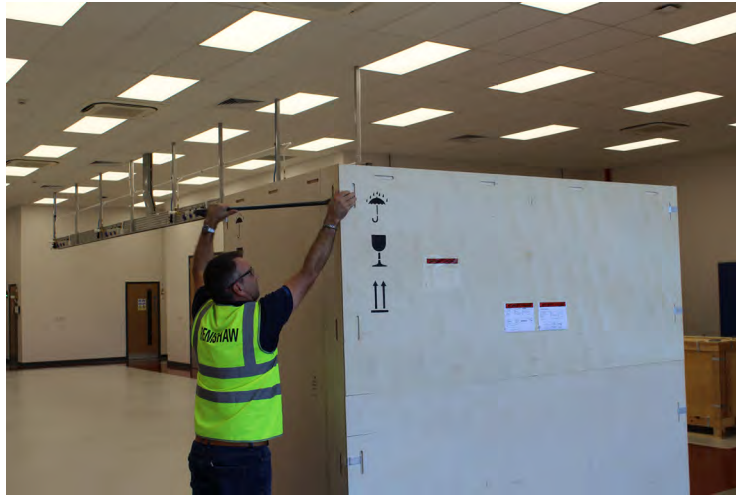
Abbildung 47 Die vier Befestigungsklammern an der vorderen oberen Platte entfernen
