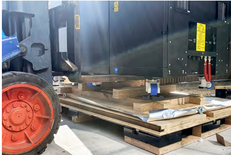
Abbildung 63 Das System von der Bodenplatte der Transportkiste entfernen
