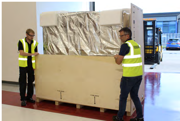
Abbildung 54 Die hintere untere Platte abnehmen
