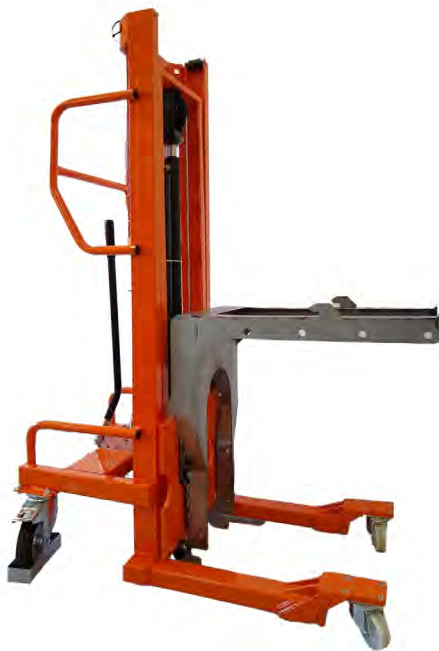
Abbildung 22 Universalheber mit angebaute Hebevorrichtung
