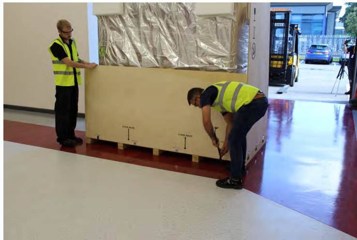
Abbildung 53 Halten und die Befestigungsklammern der hinteren unteren Platte entfernen
