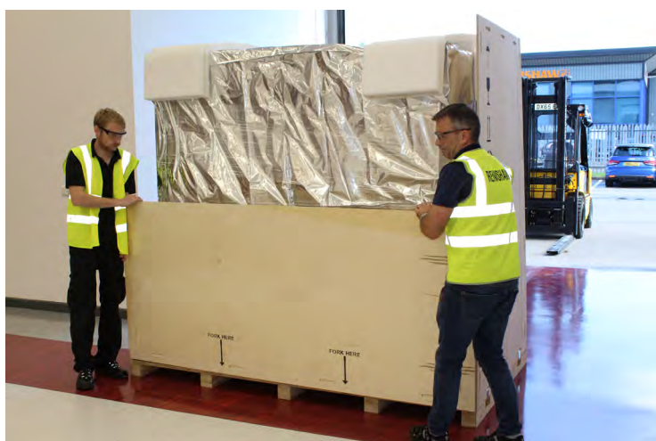
Imagen 54 Retirando el panel trasero inferior
