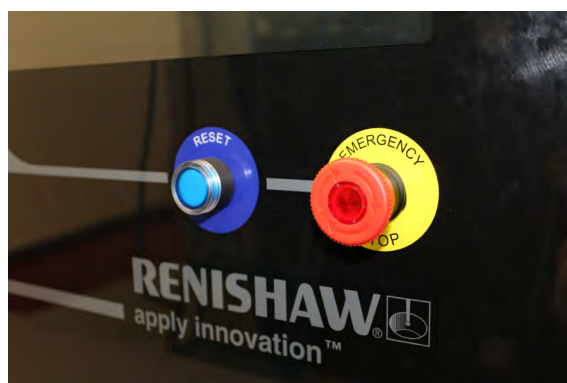
Imagen 4 Botón Stop de parada de emergencia en la parte frontal de la máquina serie RenAM 500
