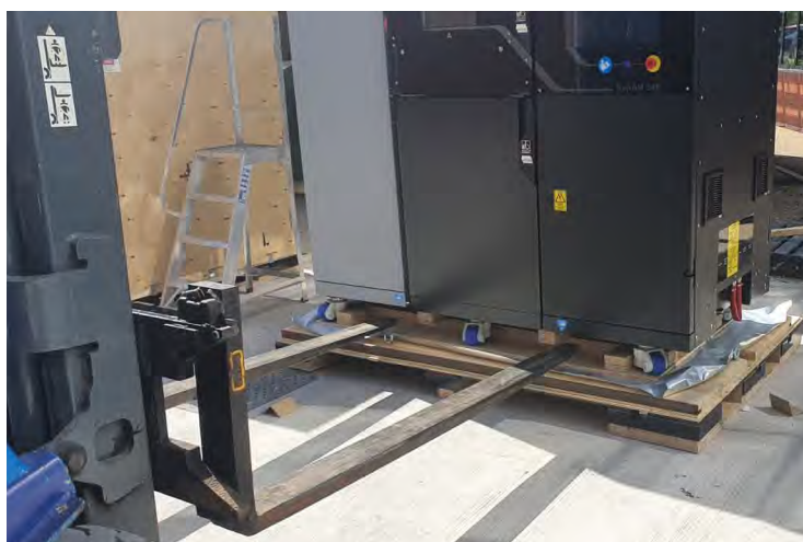
Imagen 62 Alinee las horquillas con los símbolos de los puntos de elevación para carretillas.
