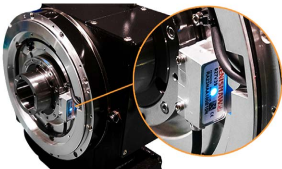
그림 1. 다이렉트 드라이브 모터에 설치된 Renishaw의 RESOLUTE™ RESA 로터리 엔코더(SOLPOWER, 대만).
