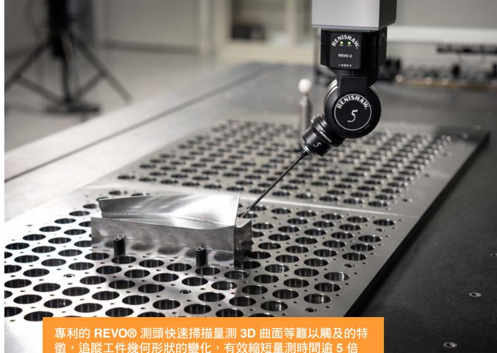
專利的 REVO® 測頭快速掃描量測 3D 曲面等難以觸及的特徵，追蹤工件幾何形狀的變化，有效縮短量測時間逾 5 倍
