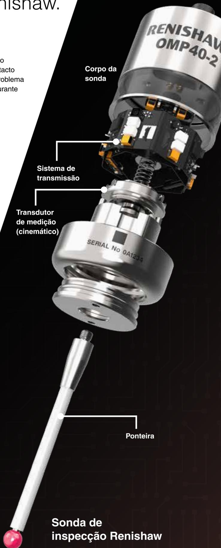
Sonda de inspeção Renishaw
