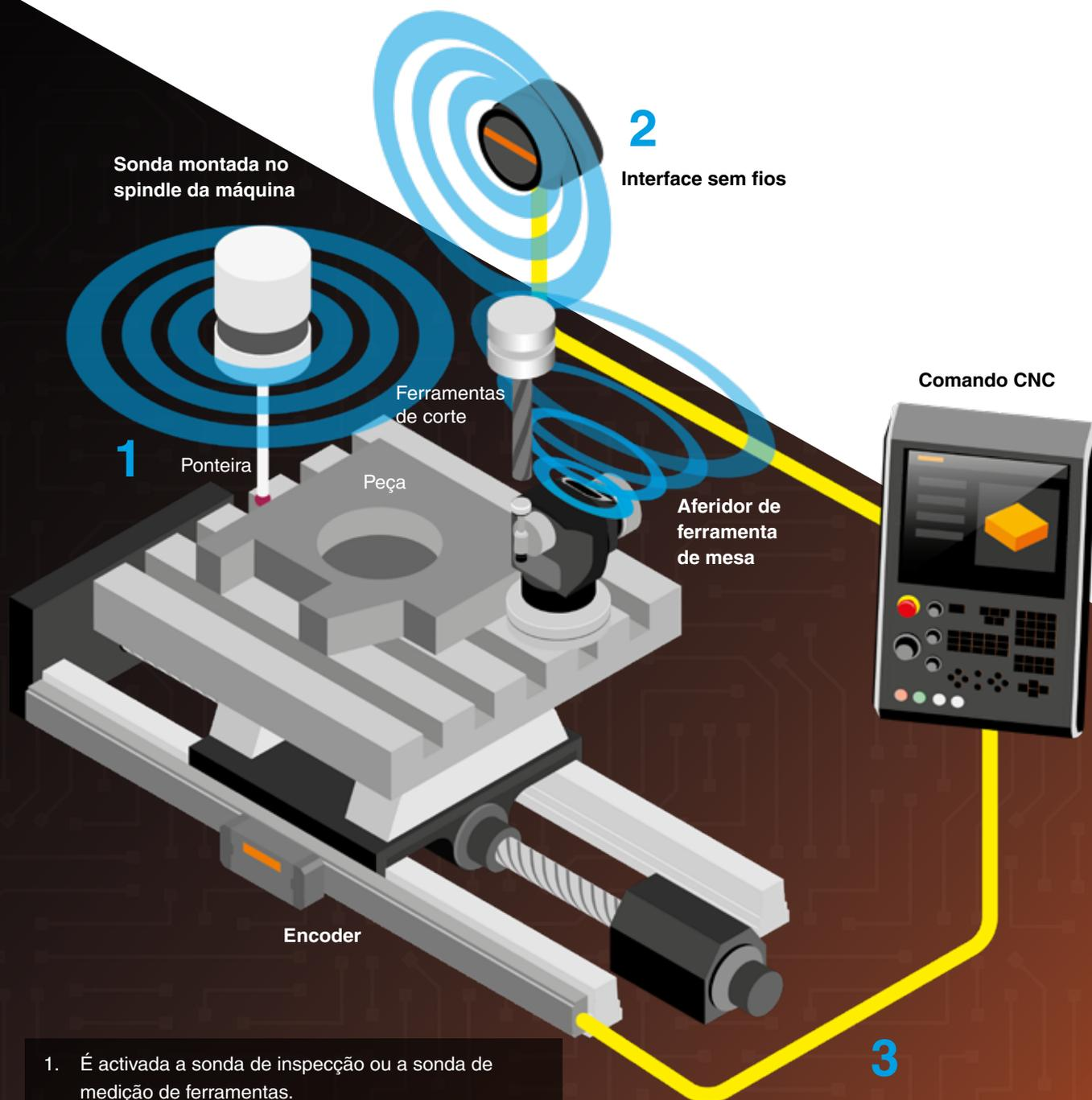
1. É activada a sonda de inspecção ou a sonda de medição de ferramentas.
