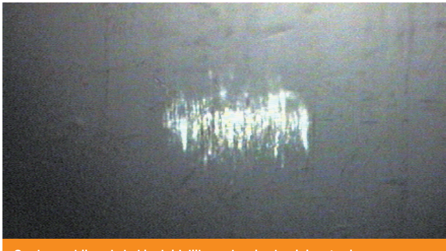
Op deze robijnrode bal is duidelijk een laagje aluminium te zien.
