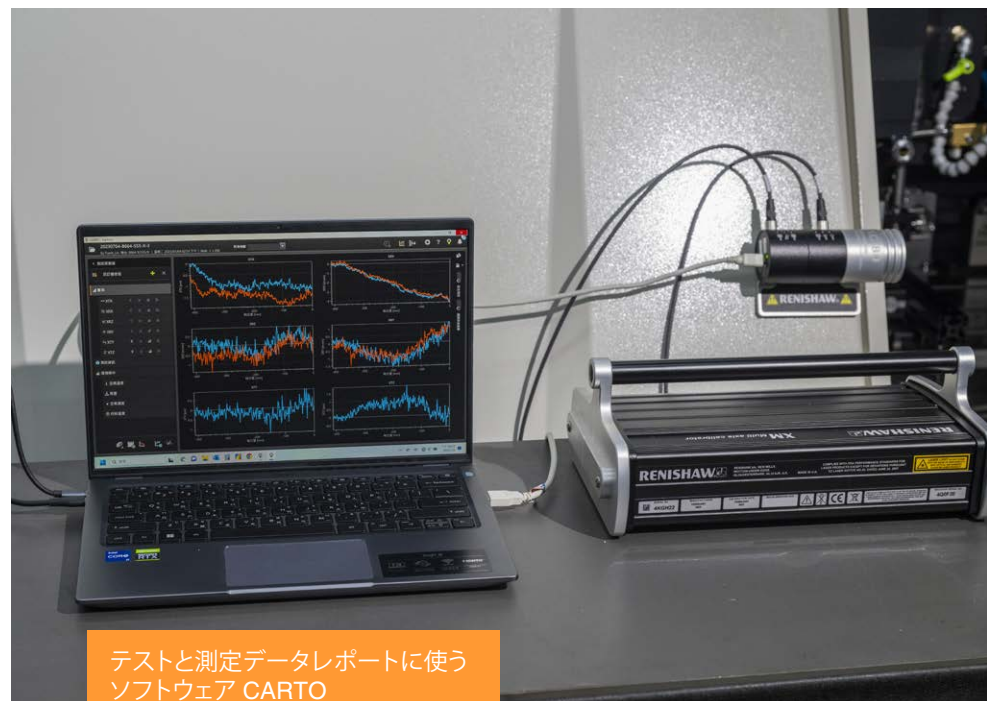
XM-60 マルチアクシスキャリブレータの包括的な測定機能により、CMAT 社は機械の状態を評価してキャリブレーションに活かせるようになった。
