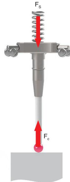
图9: Z方向上力的平衡
