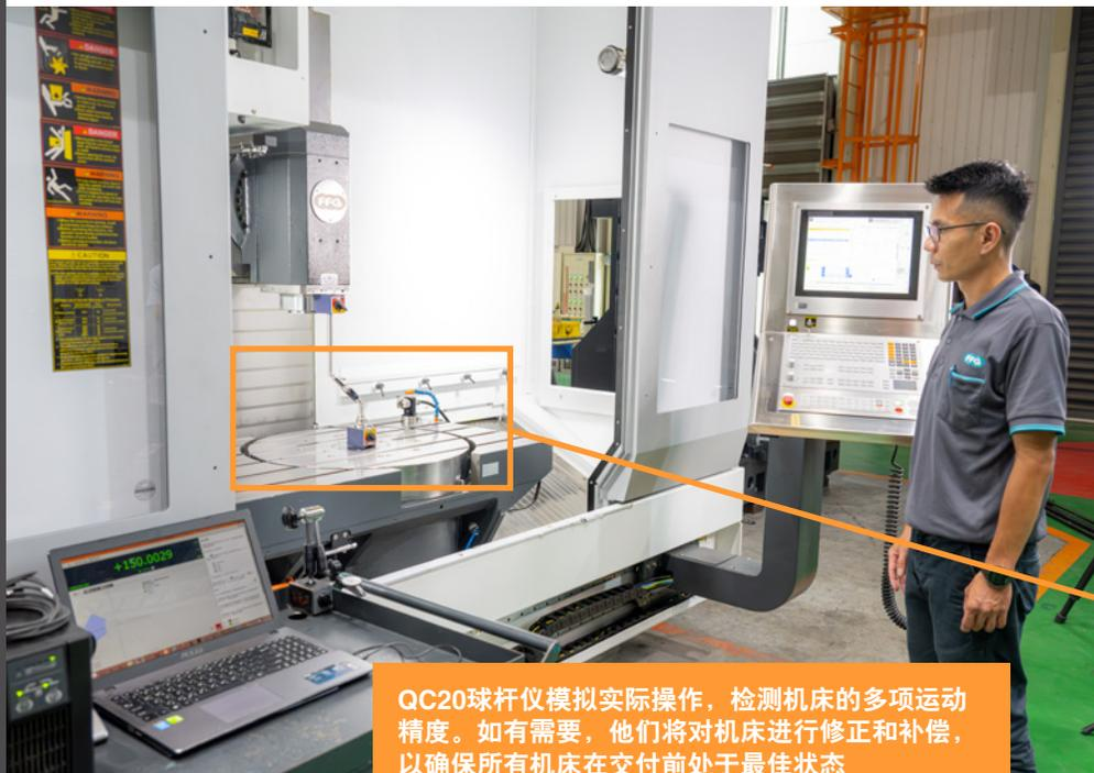
QC20球杆仪模拟实际操作，检测机床的多项运动精度。如有需要，他们将对机床进行修正和补偿，以确保所有机床在交付前处于最佳状态
