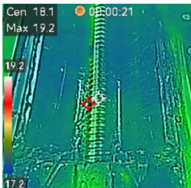
图3: 室温状态下机床的热图像(热成像图) 清楚显示, 这时滚珠丝杠的温度与机床的整体温度基本一致。
