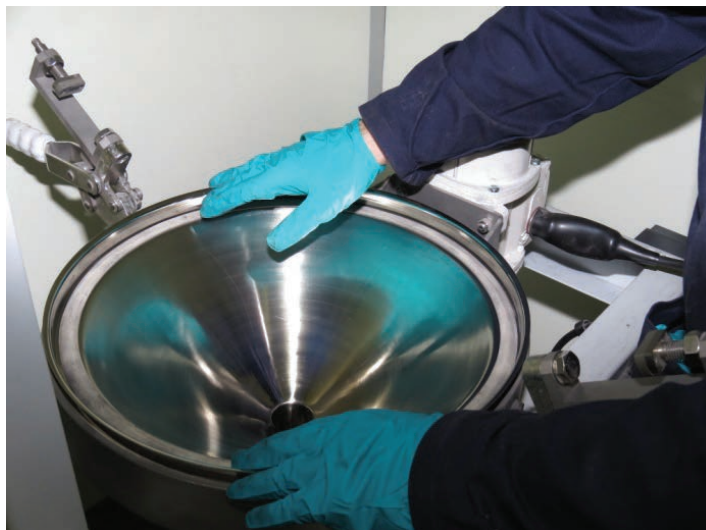
Figura 38 Recoloque a vedação do funil
