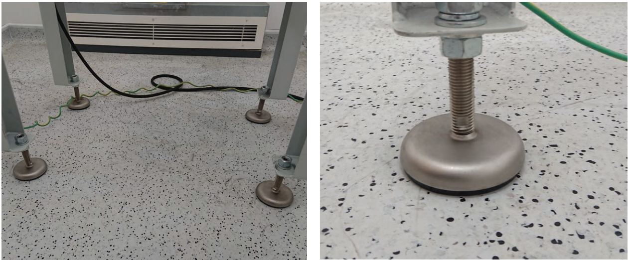
Figura 6 Sistema de Recuperação de Pó Renishaw (PRS). Quatro pés ajustáveis (esquerda) e detalhe de um pé (direita)
