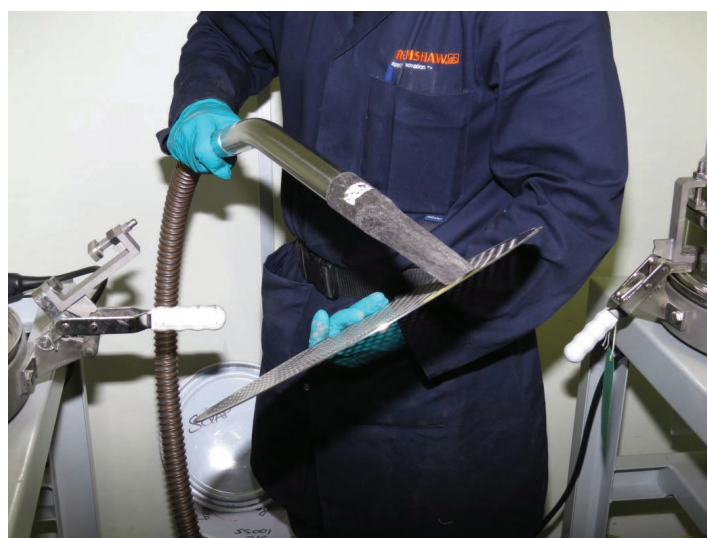
Figura 35 Utilize o aspirador ATEX para aspirar todos os componentes
