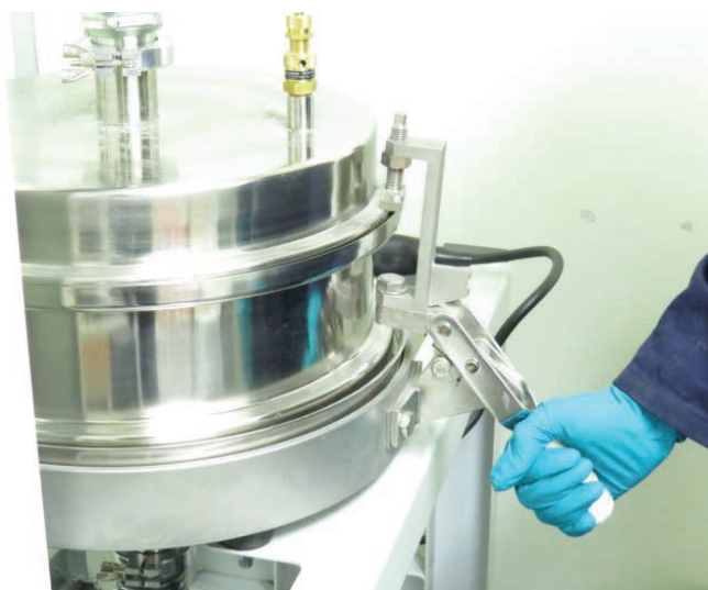
Figura 23 Solte as duas braçadeiras
