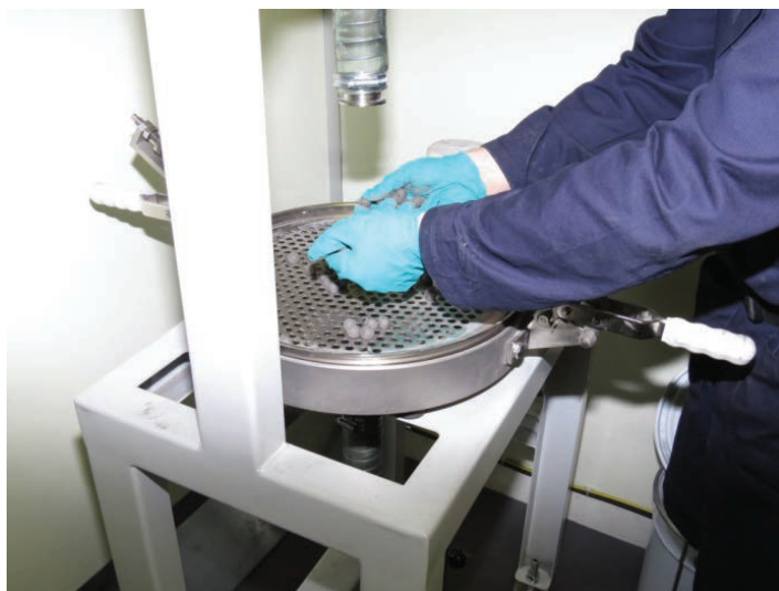
Figura 29 Retire as esferas e guarde em IPA
