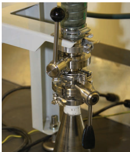
Figura 14 Válvula de isolamento inferior do PRS
