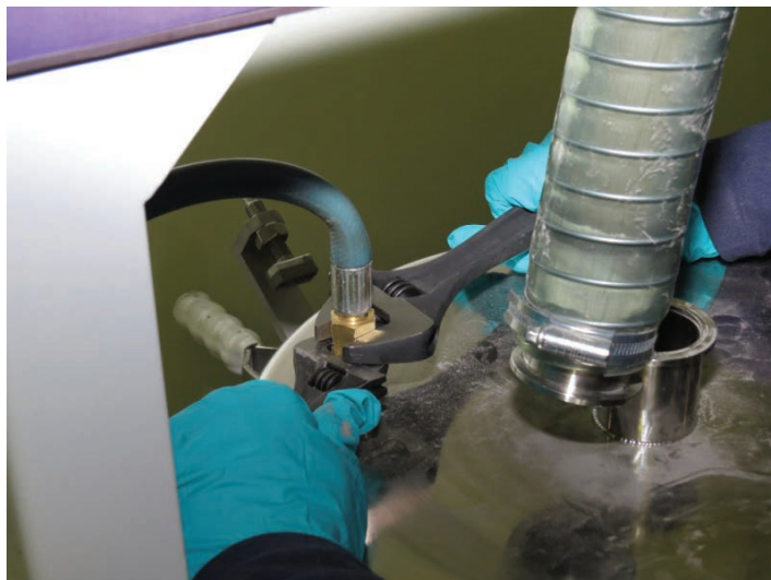
Figura 24 Se instalado, remova o fornecimento de argônio
