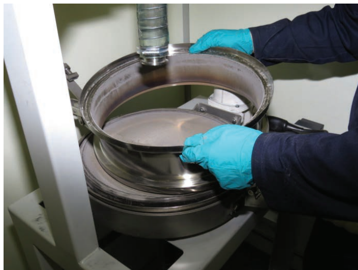
Figura 26 Remover corpo do PRS
