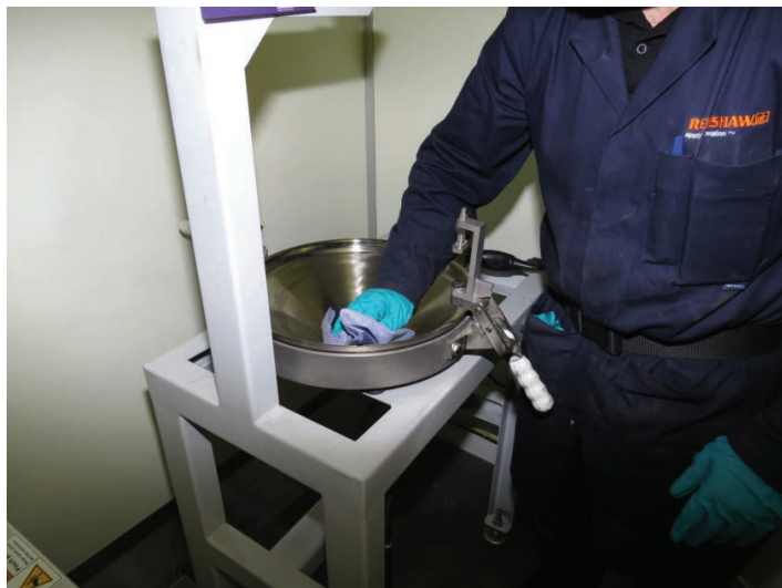
Figura 36 Limpe todos os componentes com IPA Classe 3
