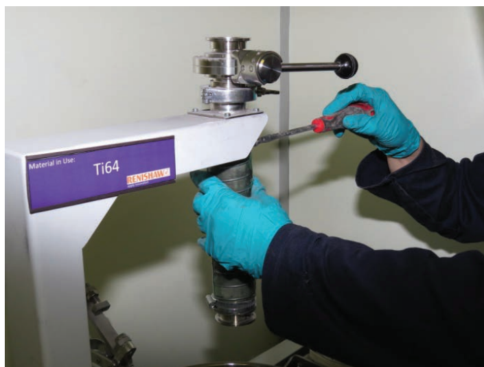
Figura 32 Remova a braçadeira com parafuso sem-fim da mangueira
