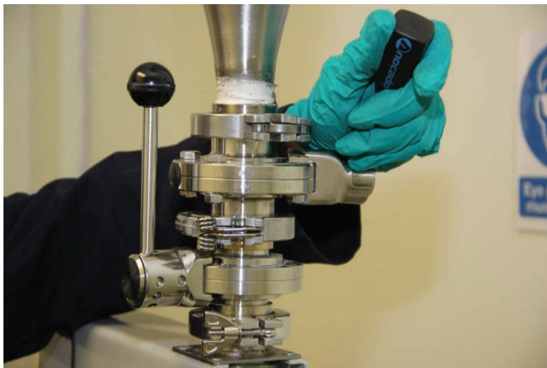
Figura 17 Válvula de isolamento superior do PRS
