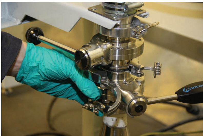
Figura 34 Remover o conjunto da válvula inferior
