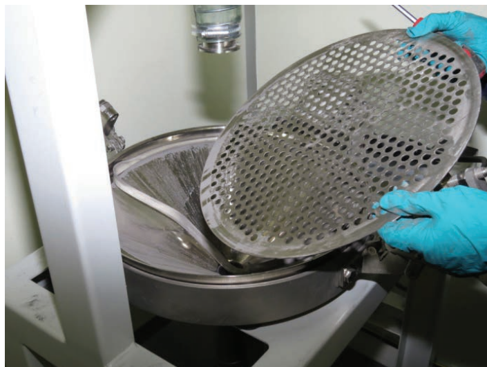
Figura 30 Remova a placa perfurada
