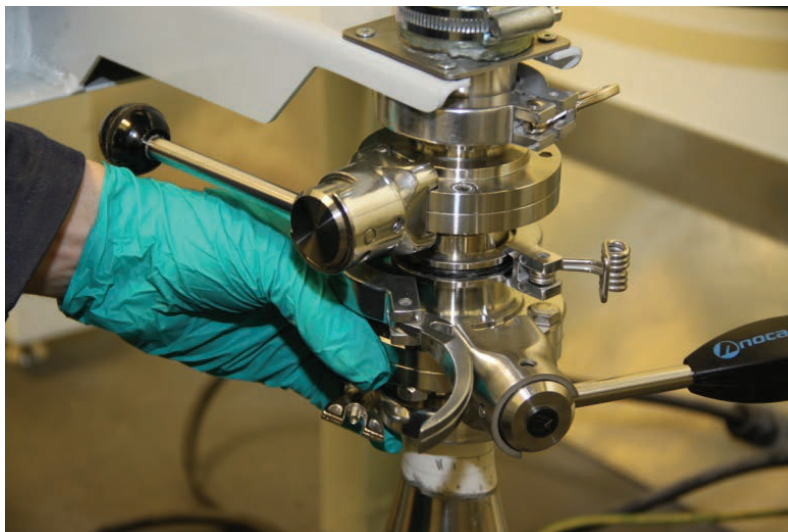
Figura 13 Encaixe a vedação central, junte e prenda com uma braçadeira de liberação rápida
