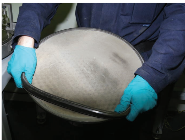
Figura 41 Monte a vedação da malha
