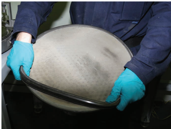
Figura 28 Remova a vedação externa
