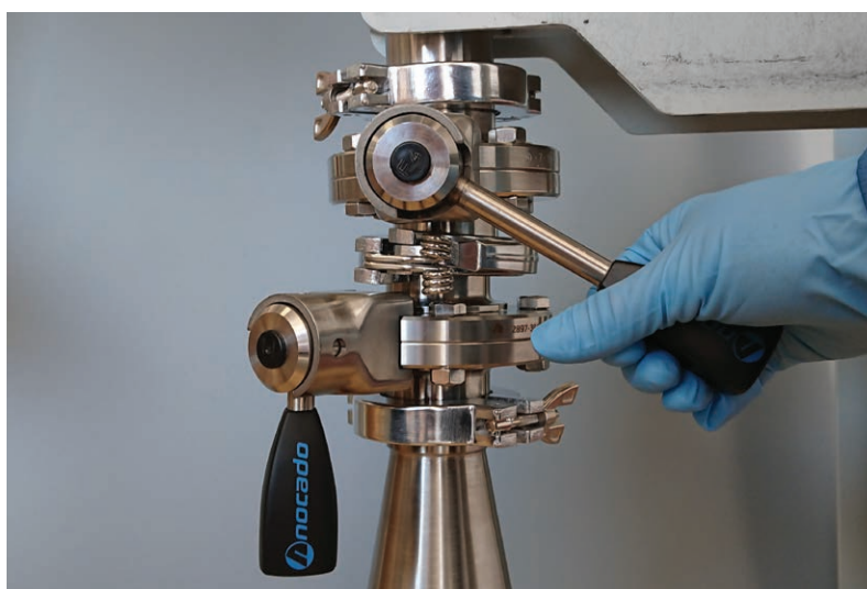
Figura 20 Feche as válvulas de isolamento do frasco de pó e do PRS inferior
