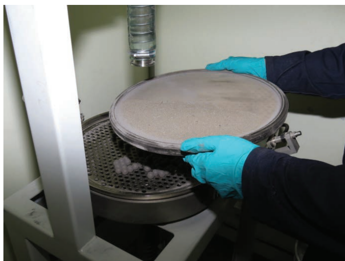
Figura 27 Remova o PRS e descarte qualquer pó
