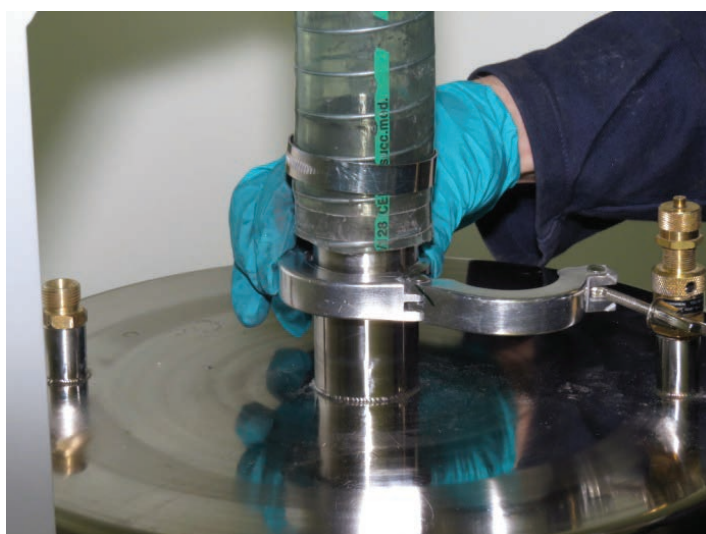
Figura 47 Conecte o inserto do tubo à tampa usando uma braçadeira de liberação rápida
