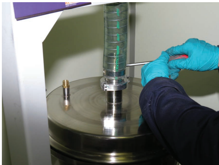
Figura 48 Apertar braçadeira da mangueira com sem-fim
