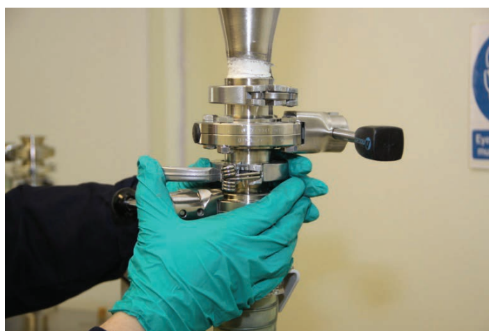
Figura 16 Coloque uma vedação de centralização, um frasco de pó cheio e prenda com uma braçadeira de liberação rápida
