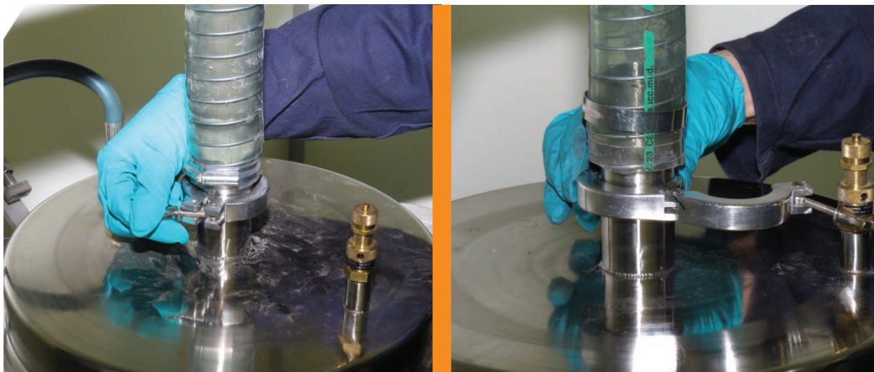
Figura 22 Remover a braçadeira com parafuso
