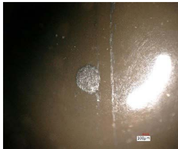
图2 测试完成后测球的显微照片 (1 – 红宝石测球, 2 – 氮化硅测球, 3 – OPTiMUM钻石涂层测球)。
