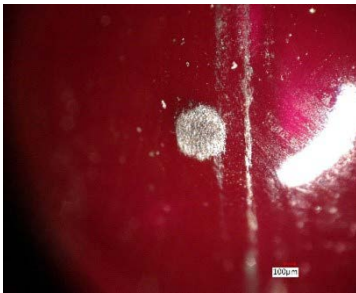
图2 测试完成后测球的显微照片 (1 – 红宝石测球, 2 – 氮化硅测球, 3 – OPTiMUM钻石涂层测球)。
