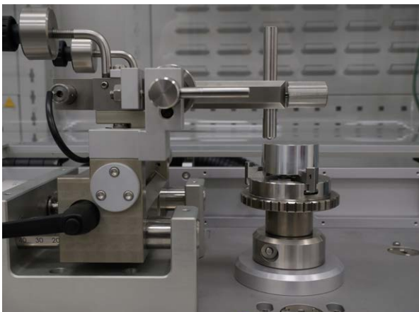
图4 销盘式摩擦磨损测试机，展示红宝石测球与铝合金样品。
